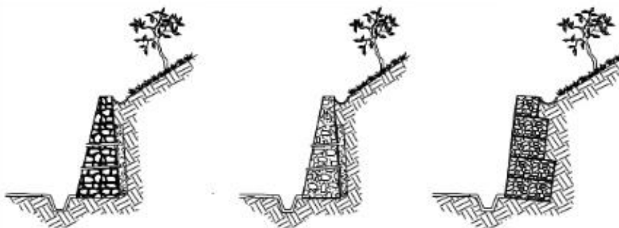
IMAGEN 8: MURO DE CONTENCIÓN POR GRAVEDAD
