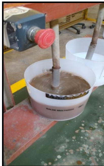
Figura 13: Tanques de Agitación.
