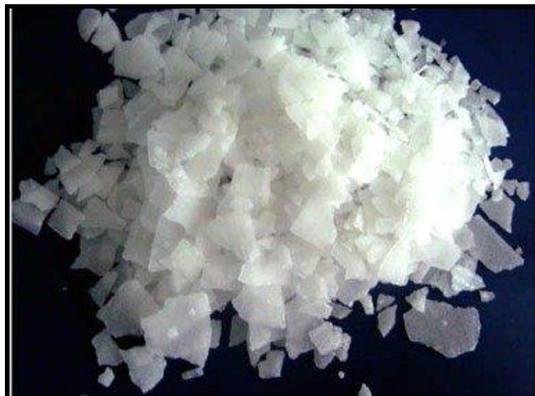
Figura 5: Hidróxido de sodio
