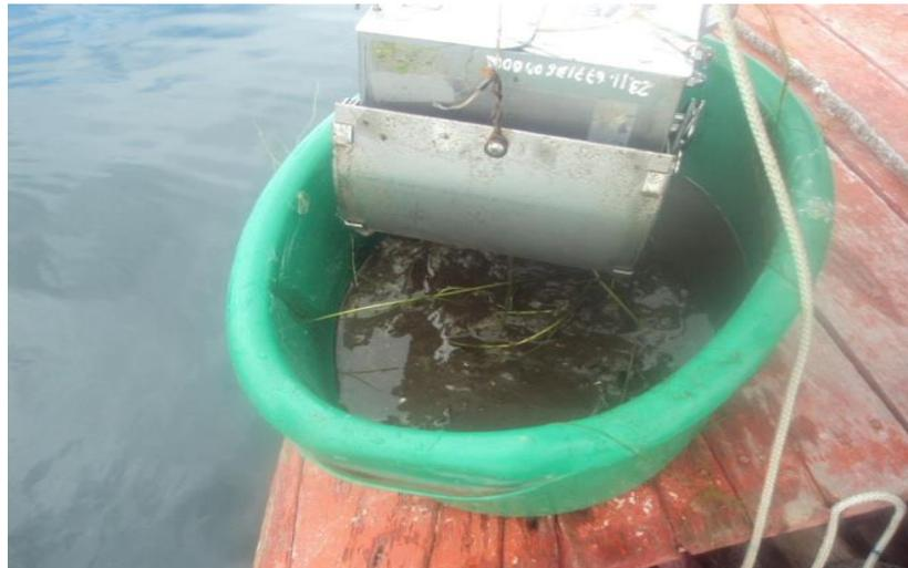
**Figura 11.** Recolección de macroinvertebrados utilizando con la Draga Ekman de 15 x 15 cm em el CITT Chucuito – Puno 2016
