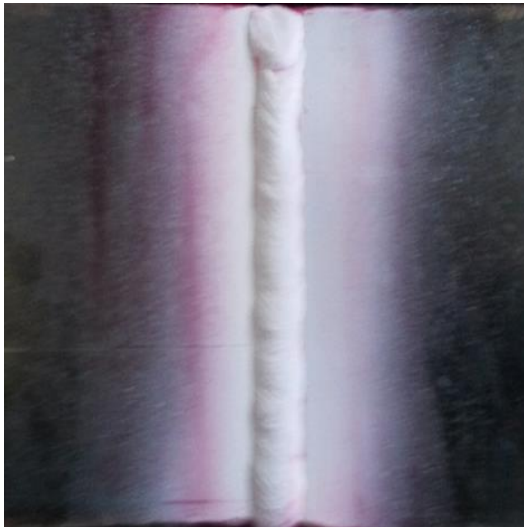
Figura N° 52. Probeta soldada con electrodo E7018 secado durante dos horas
