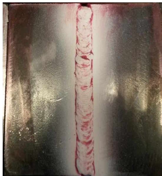
Figura N° 47. Probeta soldada con electrodo E6011 dejado a la intemperie
