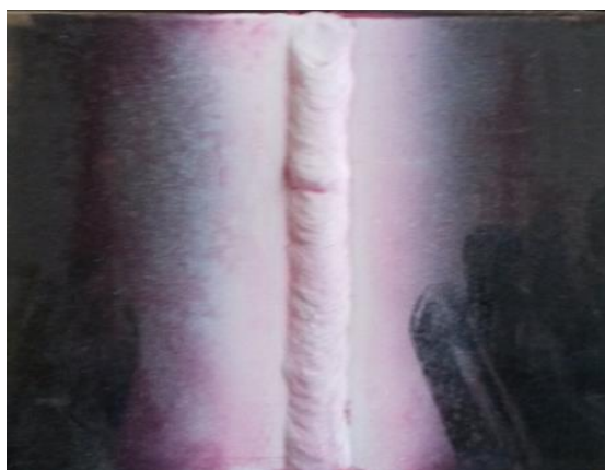
Figura N° 50. Probeta soldada con electrodo E7018 secado durante una hora
