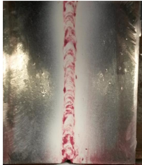
Figura N° 45. Probeta soldada con electrodo E6011 (húmedo)
