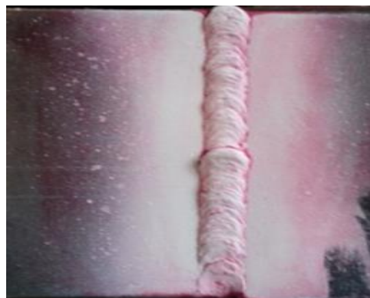
Figura N° 51. Probeta soldada con electrodo E6011 secado durante una hora
