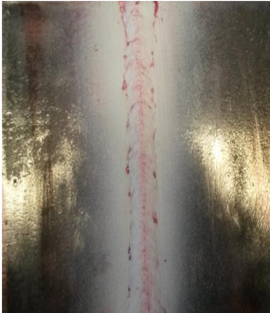
Figura N° 44. Probeta soldada con electrodo E7018 (húmedo)
