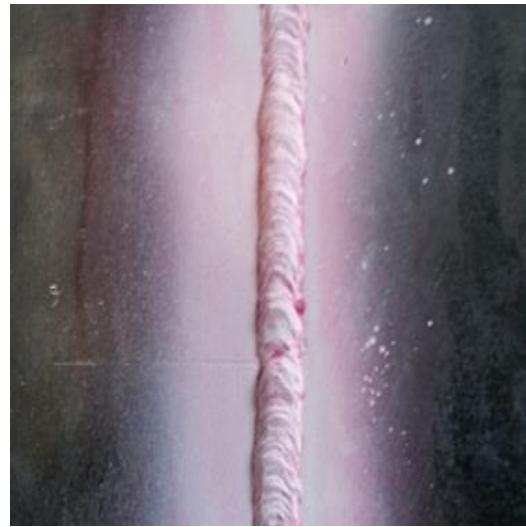
Figura N° 53. Probeta soldada con electrodo E6011 secado durante dos horas
