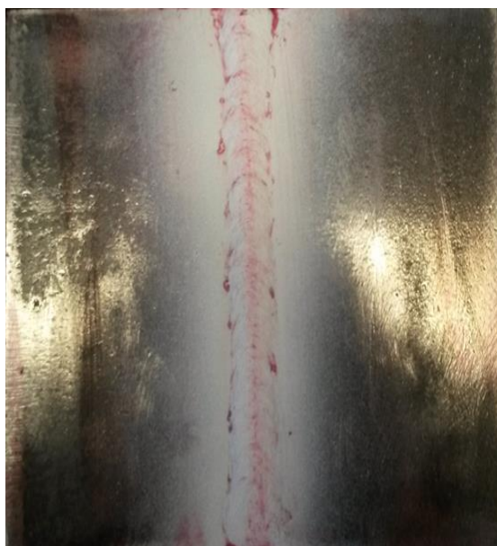
Figura N° 46. Probeta soldada con electrodo E7018 dejado a la intemperie
