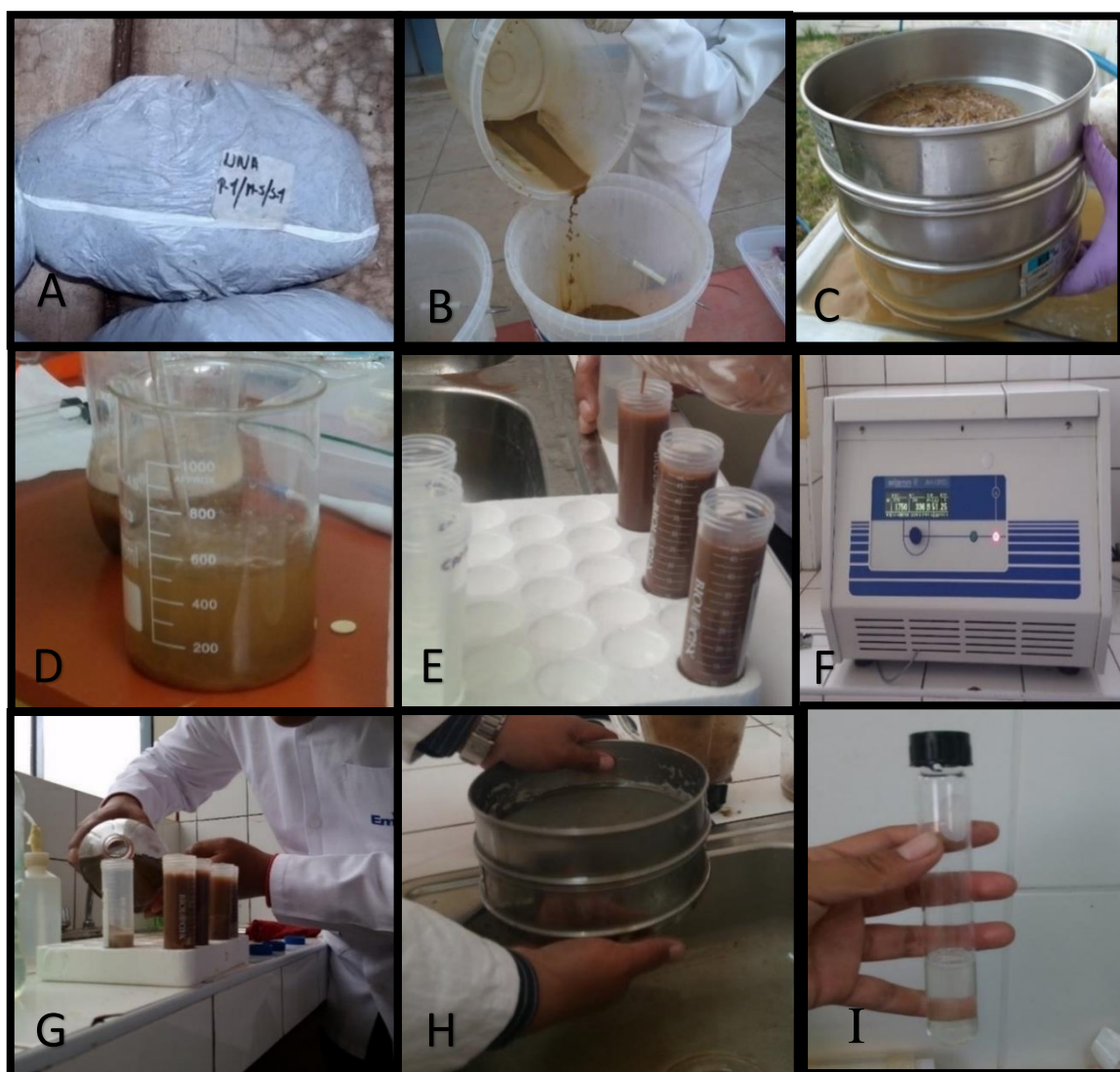
Figura 9: Proceso de lavado y centrifugación de las muestras de suelo de café A: Muestra de suelo de café, B: Lavado de muestra del suelo de café, C: Tamizado de suelo de café, D: Recolección de muestra de suelo de café, E: Agregado de cal a la muestra de suelo de café, F: Centrifugación de las muestras de suelo de café, G: Agregado de solución de sacarosa, H e I: Recolección de los nemátodos.
