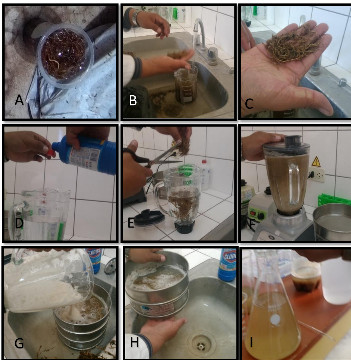
Figura 10: Proceso de lavado y centrifugación de las muestras de suelo del café; A: Muestra de raíz de café, B: Lavado de muestra de raíz, C: Muestra de raíz lavada, D: Agregado de cloro a la muestra, E: Trozado de raíz, F: Licuado de raíz, G: Tamizado de raíz, H: Lavado de muestra de raíz, I: Muestra de nemátodos.
