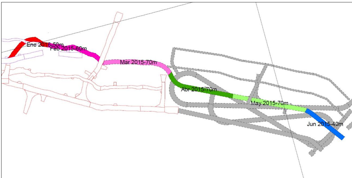
Figura N° 20: Diseño nivel 4490 (tajo 0991-tajo 1011)-vista planta Fuente: Autor de tesis
