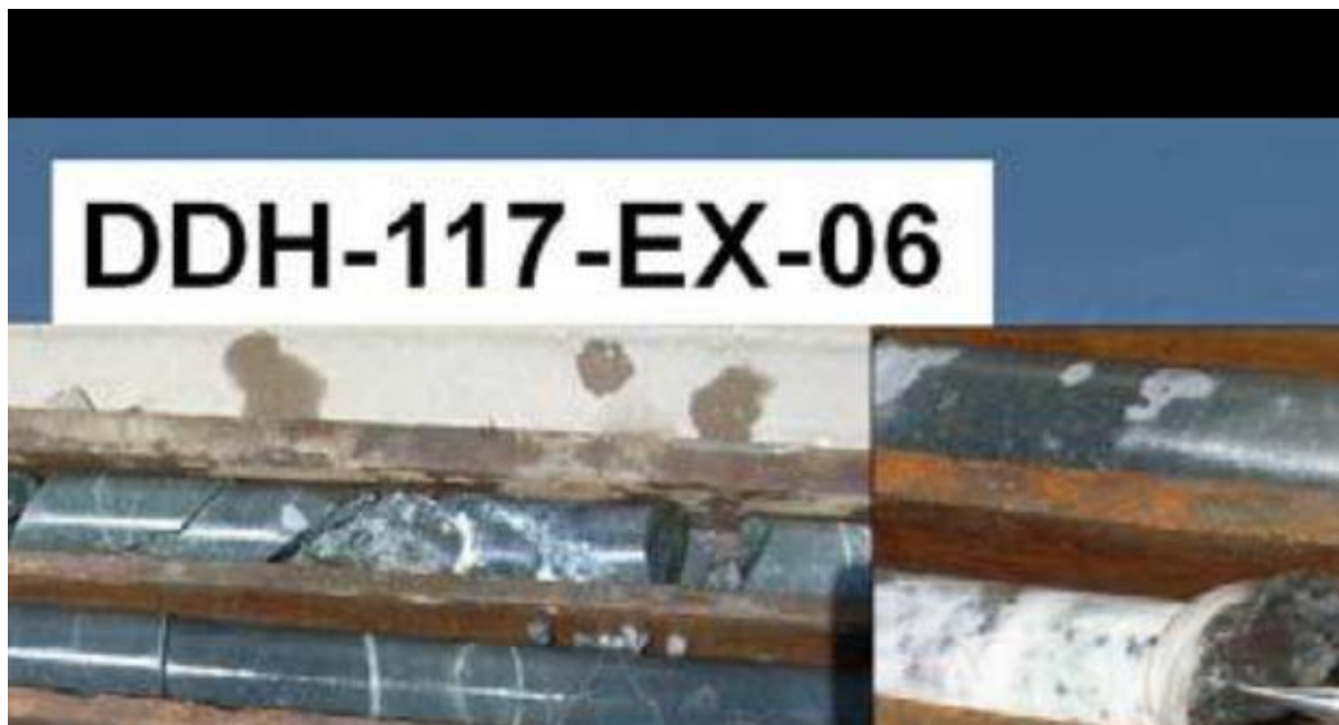
Figura N° 1: Muestra DDH (taladro diamantino) Fuente: Área de geología U.O. ARCATA
