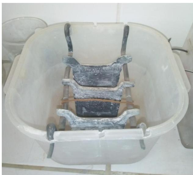
**Figura 18:** Tanque de electrodeposición B
