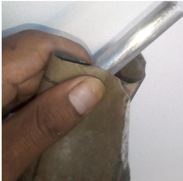
**Figura 14:** Metal en proceso de pulido
