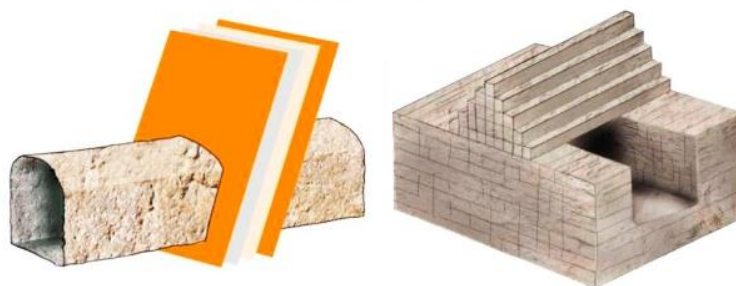
Figura 9 Condiciones favorables para la estabilidad de la excavación
