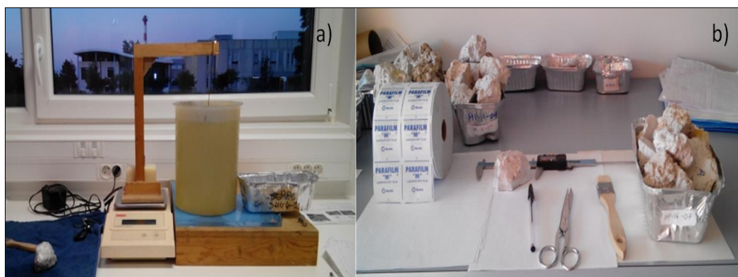
Figura 3. 2. a) Procedimiento y aplicación del Principio de Arquímedes b) instrumentos.
