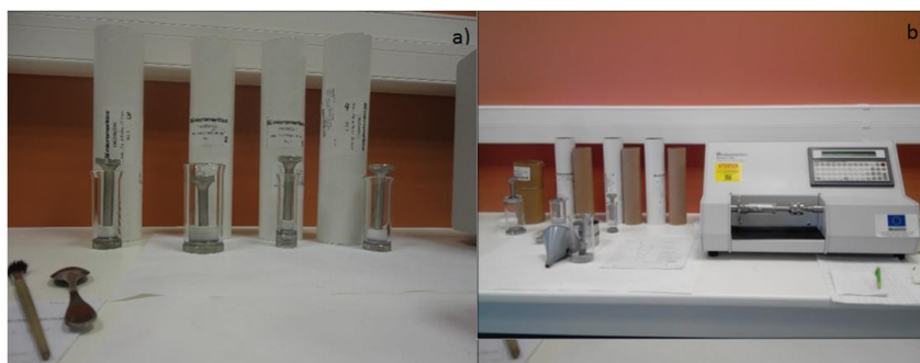
Figura 3. 4. a) Cuatro émbolos de vidrio utilizados de diámetro 50.8, 38.1, 25.4, 19.1, 12.7 mm b) Picnómetro mecánico e instrumentos utilizados para el análisis de densidad.
