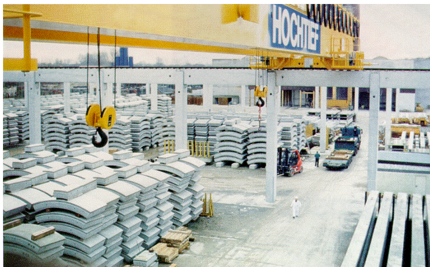
FIGURA 2.34: grúa de 64tn con control fuzzy para el antipandeo
