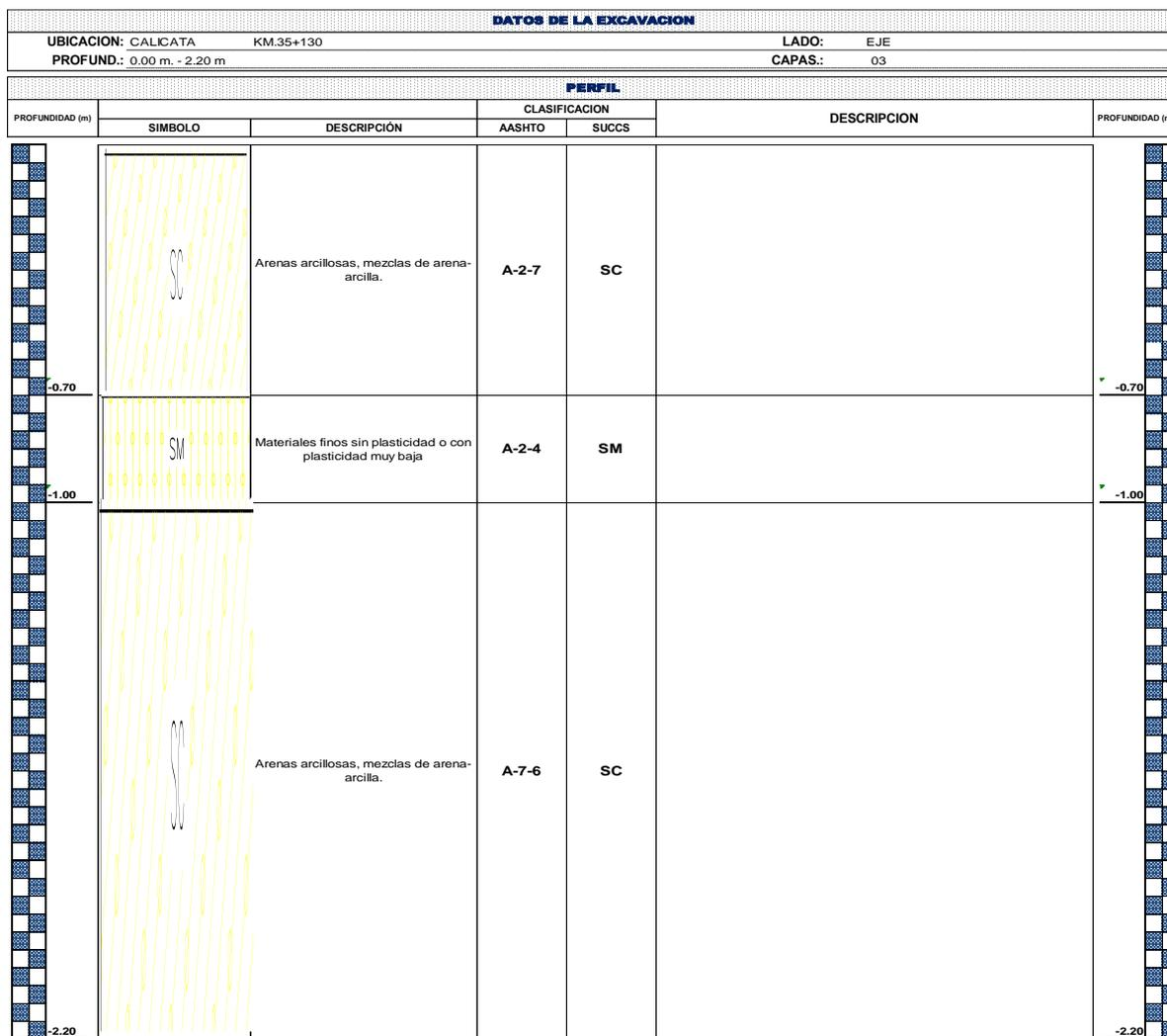
FIGURA 22. ANALISIS DE PERFIL DEL SUELO PROG. Km. 30+000 a35+130
