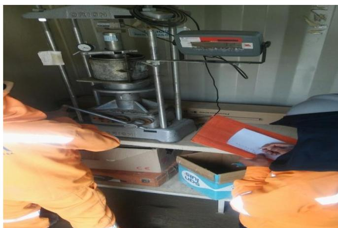
FIGURA 16. ILUSTRACIÓN DEL ENSAYO DE CBR.
