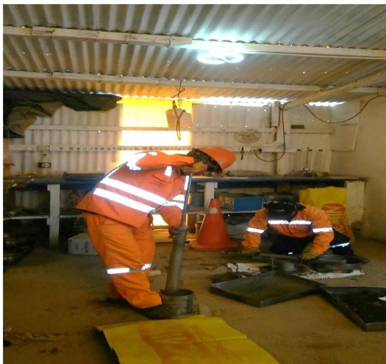
FIGURA 15.ILUSTRACIÓN DE ENSAYO DE PROCTOR MODIFICADO.
