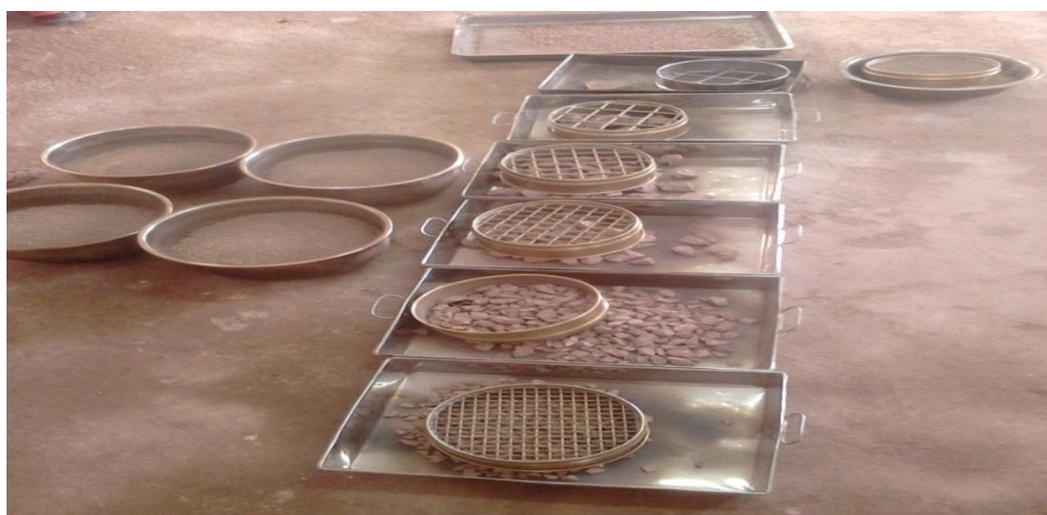
FIGURA 13.ILUSTRACIÓN DE ENSAYO DE GRANULOMETRÍA.
