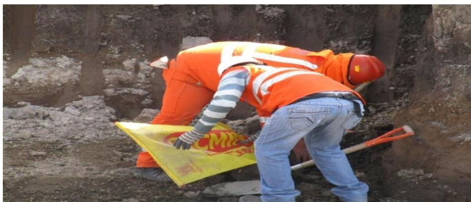
FIGURA 3. TOMA DE MUESTRAS PARA ANÁLISIS EN LABORATORIO.
