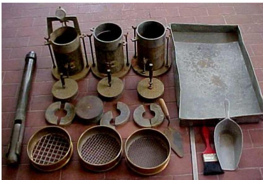
FIGURA 4.MATERIALES PARA EL ENSAYO DE CBR.
