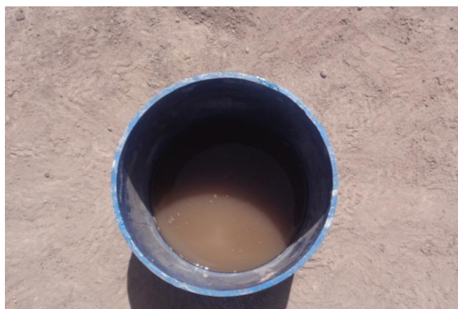
Figura N° 7. Infiltrmetro con agua.
