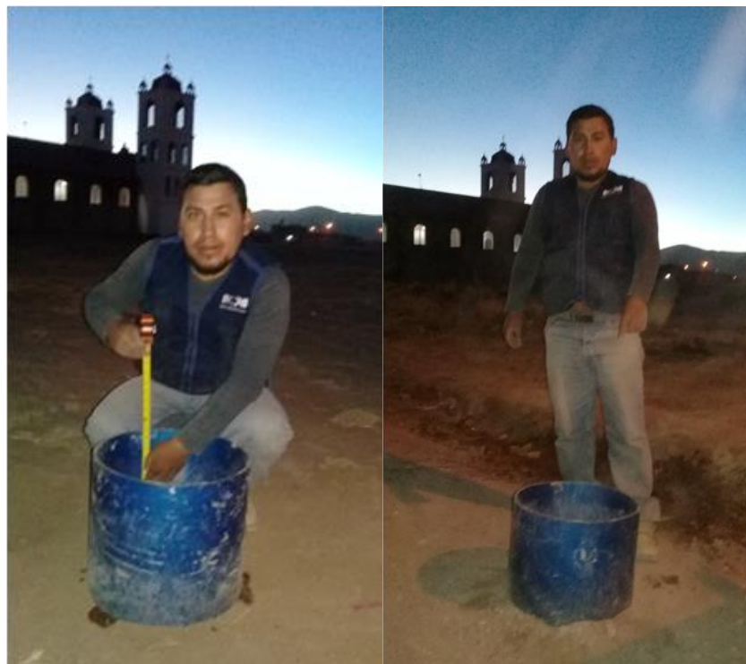
Figura N° 8. Medida de la infiltración del agua.
