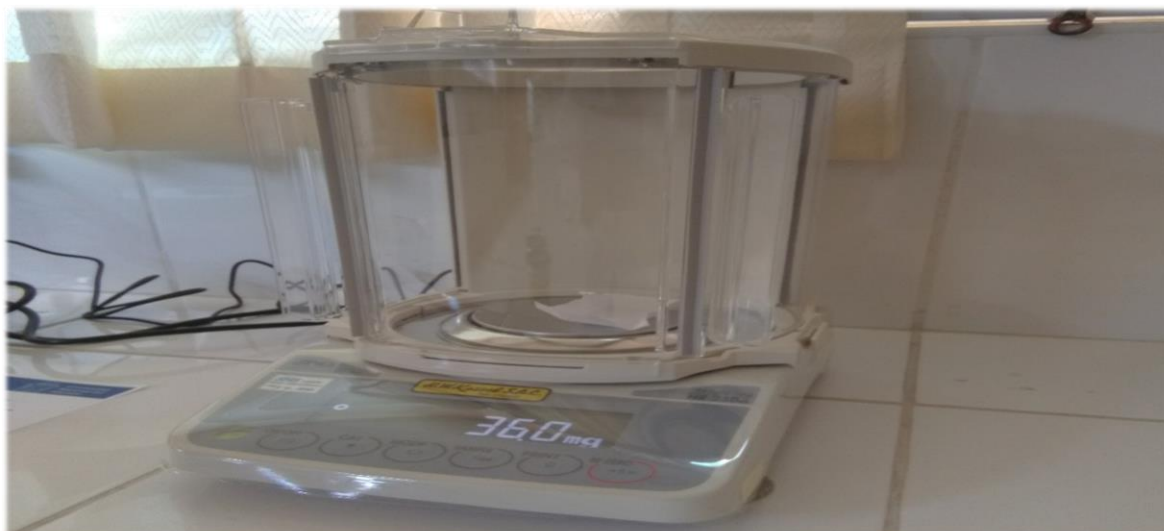
Figura 3.5. Vista de la balanza SHS HR-250A.
