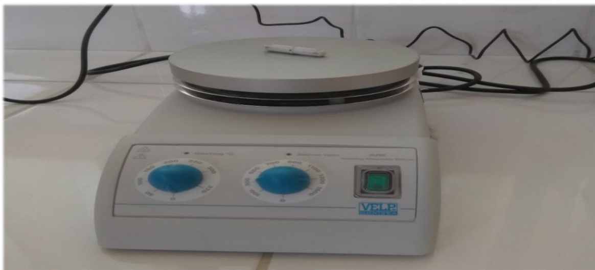
Figura 3.2. Vista del equipo Velp Científica para la prueba de jarras.
