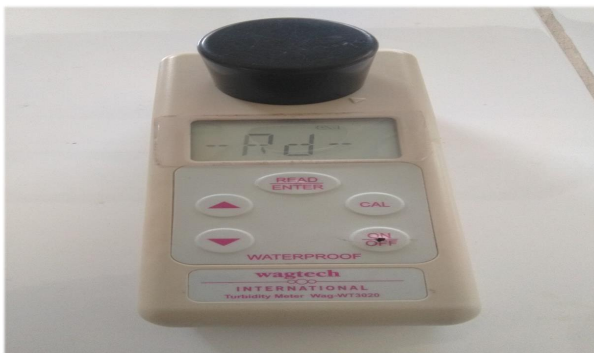
Figura 3.3. Vista del equipo Wagtech – WT3020 para medir la turbidez.
