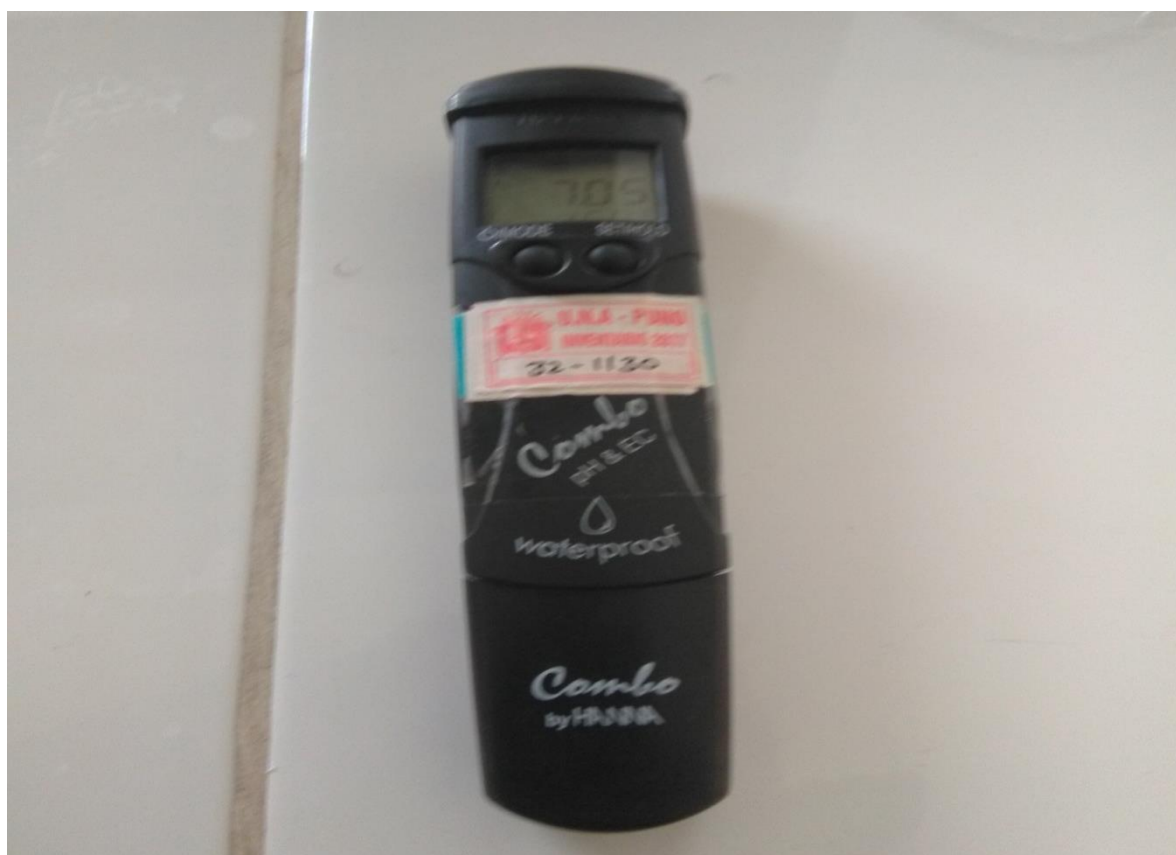
Figura 3.4. Vista del equipo Combo pH & EC para medir la temperatura, pH y SST.
