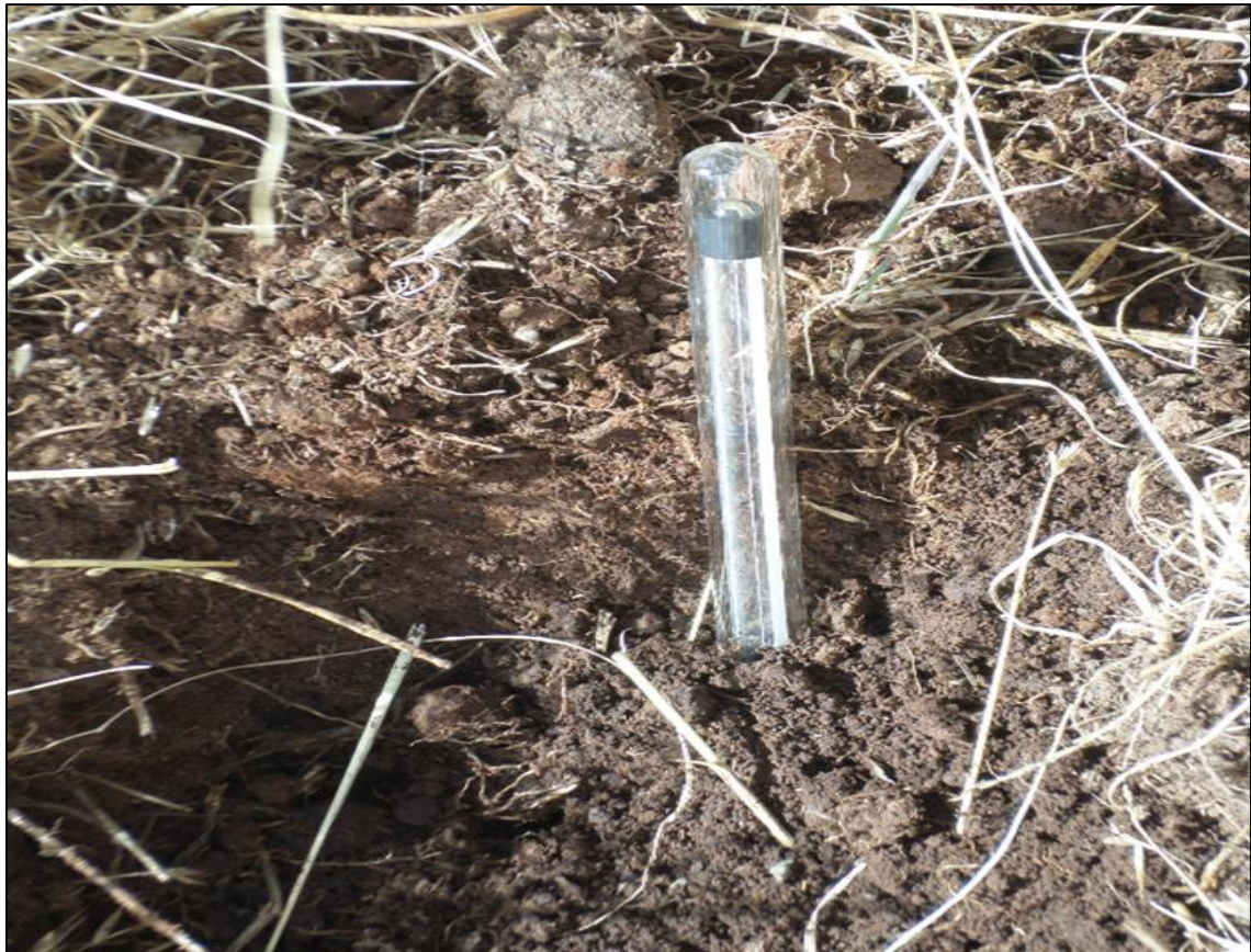
Figura 5: Lectura de la temperatura con el geotermómetro en uno de los puntos del muestreo.
