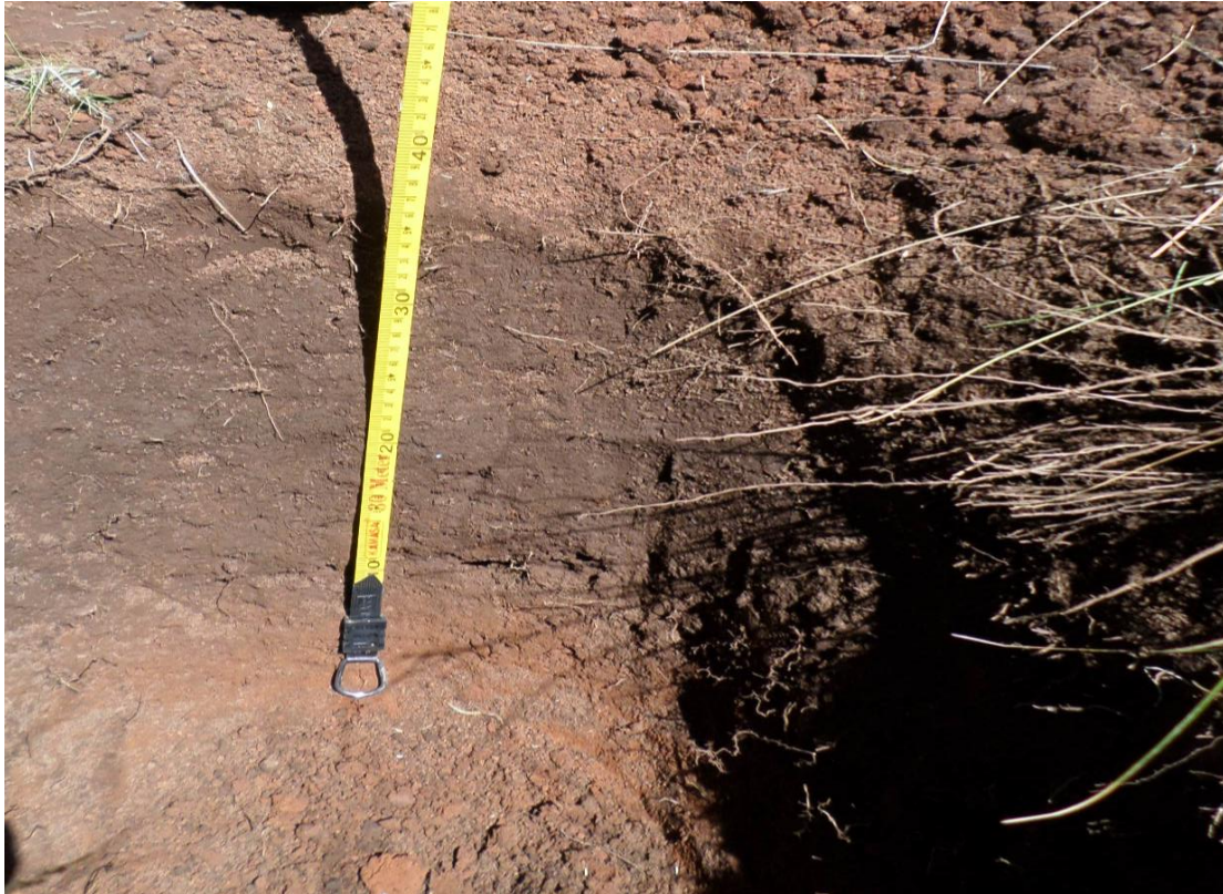
Figura 21: Apertura de 40 cm de suelo para luego realizar el muestreo del suelo.
