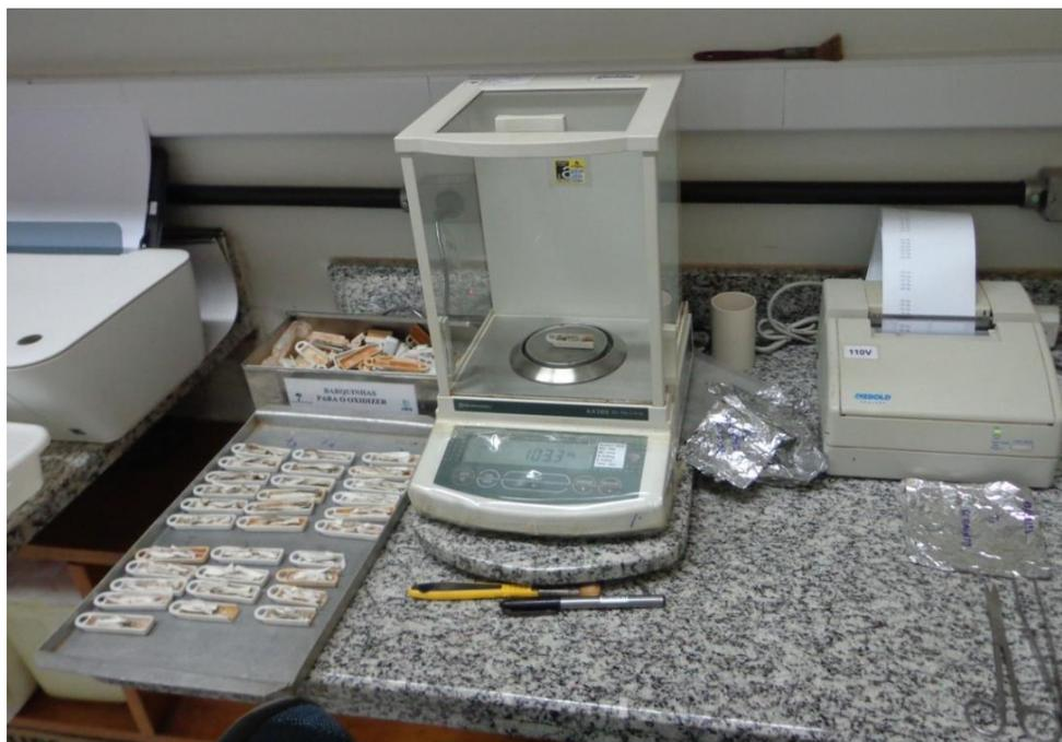
Figura 37. Acondicionamiento de muestras en los barquillos para quemar en el oxidador biológico.
