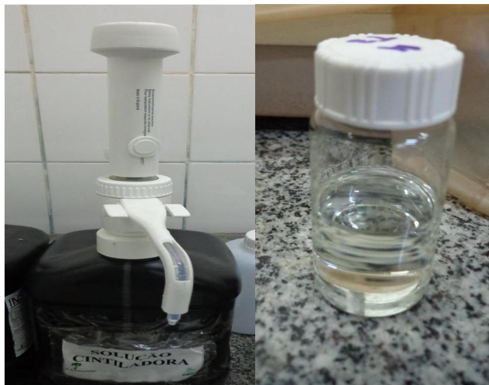
*Figura 32.* Viales con 10 ml de la solución de centelleo insta-gel plus.
