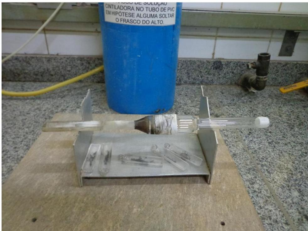
*Figura 27.* Preparación de muestras para la realización de oxidación.
