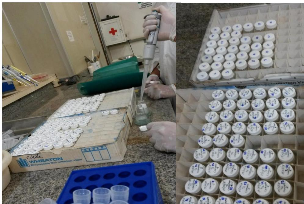
*Figura 33.* Adicionando 10 ml de muestra a los viales con 10 ml de la solución de centelleo insta-gel plus.
