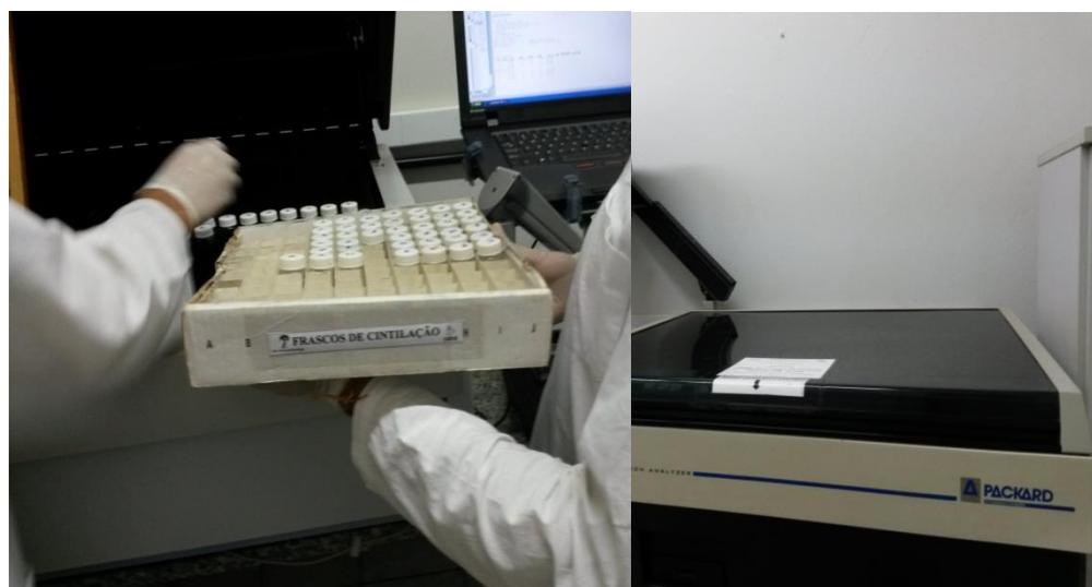
*Figura 34.* Colocando muestras al centellador líquido con un contador Tri-Carb 2910 TR LSA.
