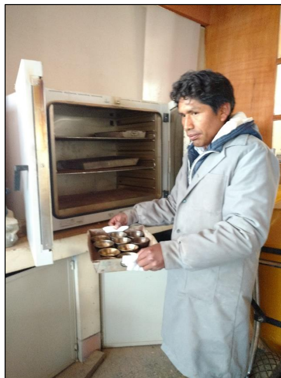
FOTO N° 46: SE OBSERVA LAS MUESTRAS PARA SU SECADO
