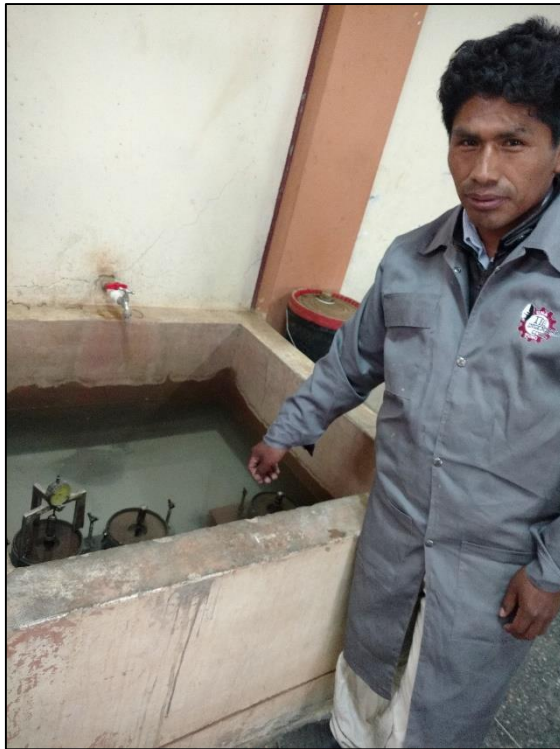
FOTO N° 57: LECTURA DE DIAL PARA DETERMINAR LA EXPANSION DE LA MUESTRA
