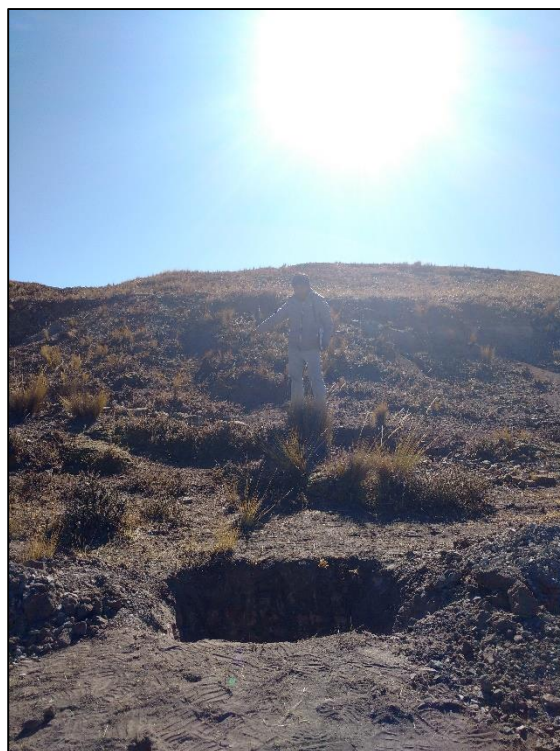
FOTO N° 26: EXCAVACION DE CALICATA PARA EXPLORACION DE LA CANTERA N° 2
