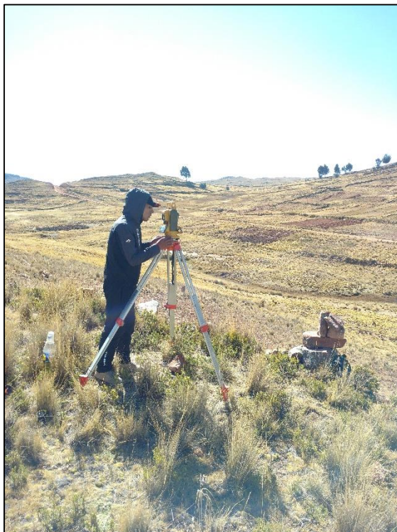
FOTO N° 07: PUNTO DE ESTACION PARA LEVANTAR PUNTOS POR REDIACION
