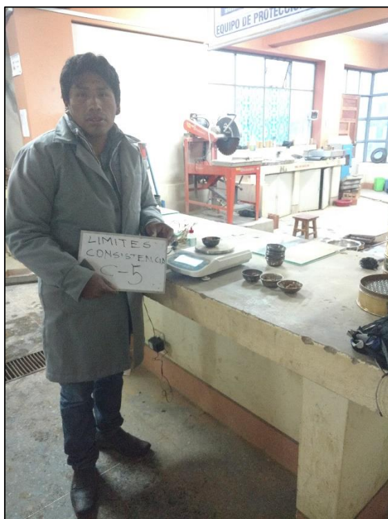
FOTO N° 47: SE OBSERVA PESADO DE MUESTRAS PARA CONTENIDO DE HUMEDAD
