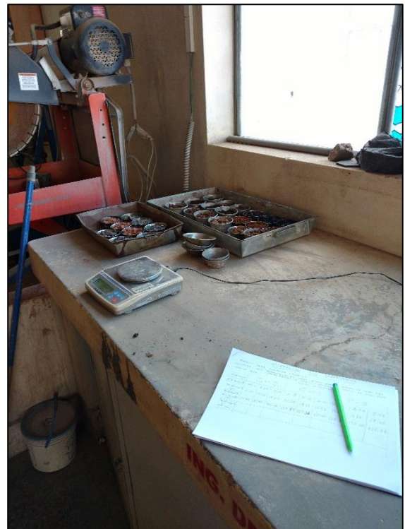
FOTO N° 32: ESTUDIO DE CONTENIDO DE HUMEDAD
