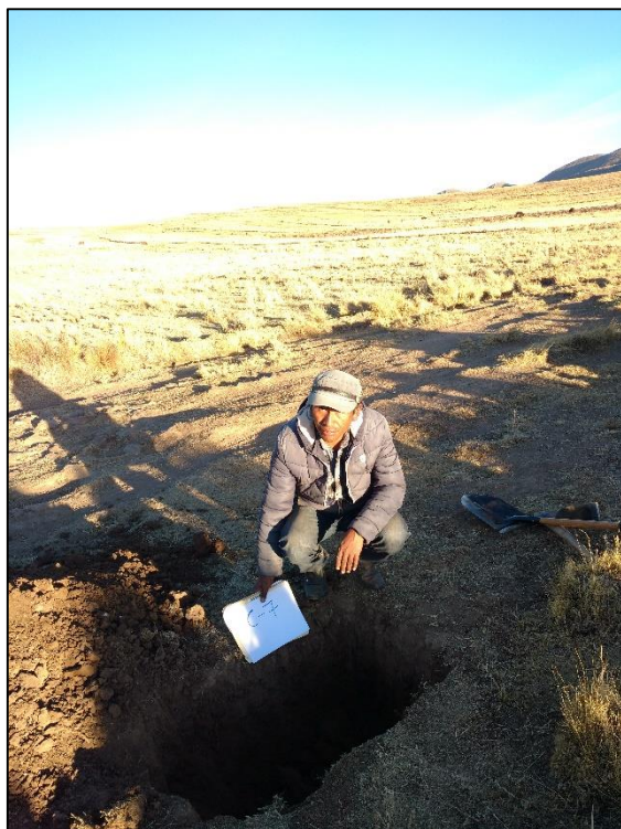
FOTO N° 23: SE OBSERVA EXPLORACION DE CALICATA PARA SU ESTUDIO DE SUELOS
