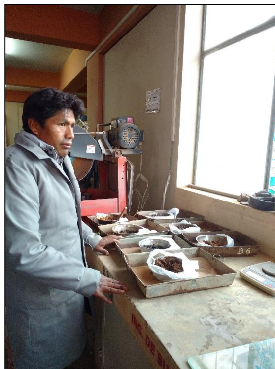
FOTO N° 38: MUESTRA PREPARADA PARA ESTUDIO DE LIMITES DE CONSISTENCIA
