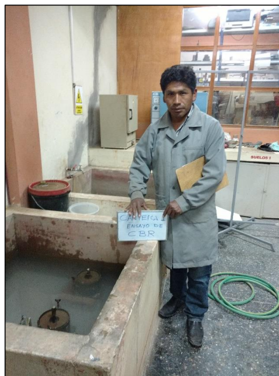
FOTO N° 56: SUMERGIDO DE LA MUESTRA PARA SU ENSAYO DE CBR
