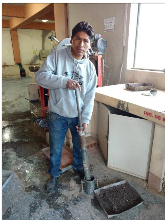
FOTO N° 55: COMPACTADO DE MUESTRA PARA ENSAYO CBR
