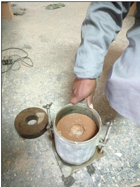
FOTO N° 59: EXTRACCION DE MUESTRA DESPUES DEL ENSAYO DEL CBR
