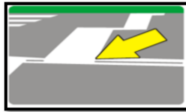
Figura N° 57: Líneas de pare
