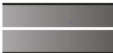
Figura N° 51: Línea central continua
