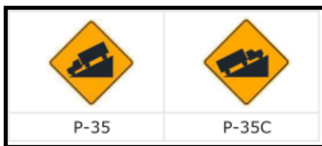
Figura N° 23: Señales preventivas – pendiente longitudinal
