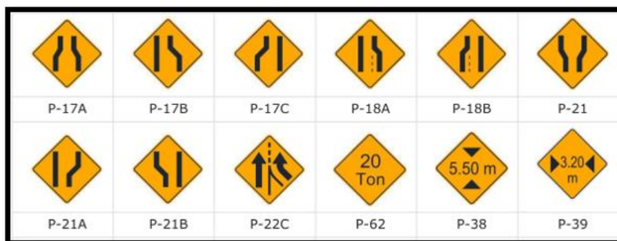
Figura N° 25: Señales preventivas por restricciones físicas de la vía
