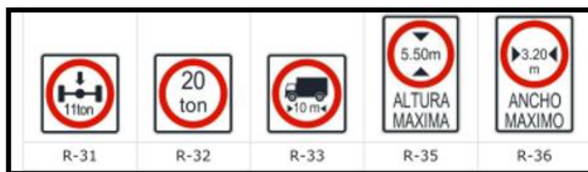
Figura N° 37: Señales de restricción B
