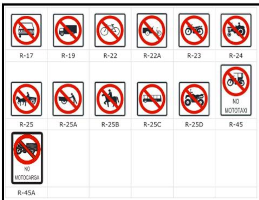
Figura N° 33: Señales de prohibición de paso por clase de vehículo
