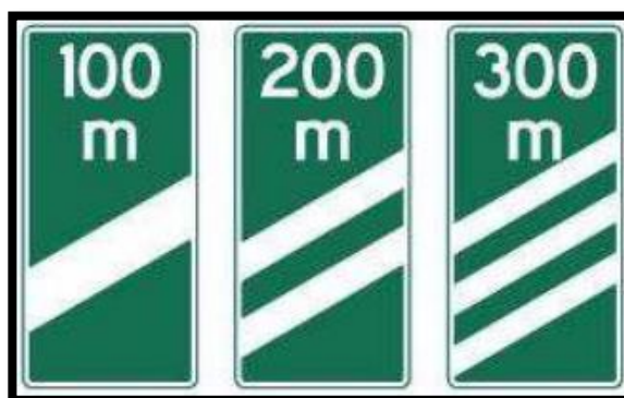
Figura N° 43: Balizas de Acercamiento
