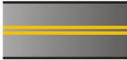
Figura N° 54: La doble línea continua
