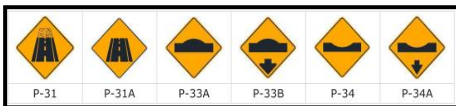
Figura N° 24: Señales Preventivas por características de la superficie de rodadura
