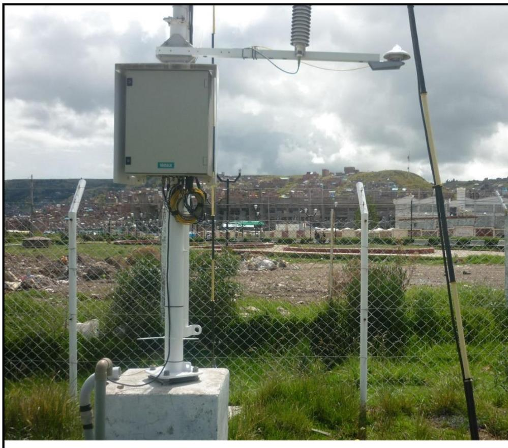
**Figura 15.** Estación meteorológica Vaisala.
