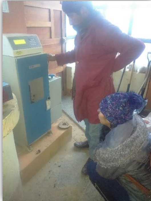
Figura 54: Supervisión de realización de ensayo de compresión inconfiada de roca en laboratorio
