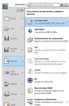
Figura 105: Paso 1 para exportación de Revit a AutoCAD
