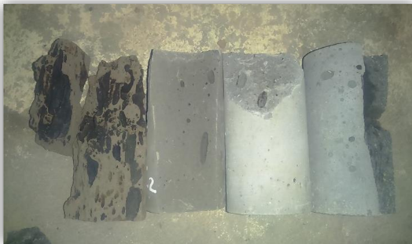
Figura 55: Muestras de rocas después de ser sometidas a ensayo de compresión inconfiada de roca en laboratorio
