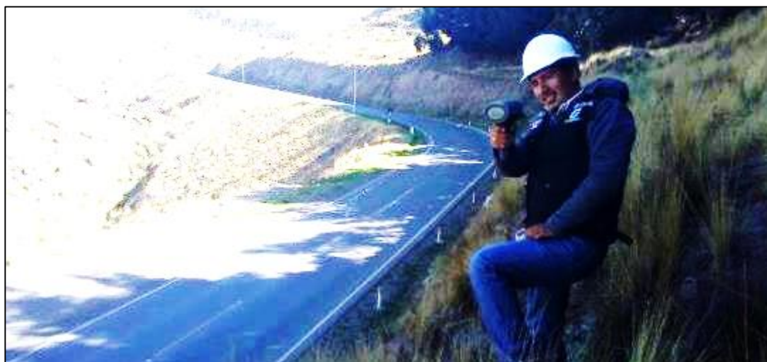
FIGURA 52: Medición de velocidad en tramo recto
