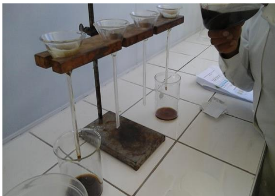
Foto 8. Filtrado de lixiviados
