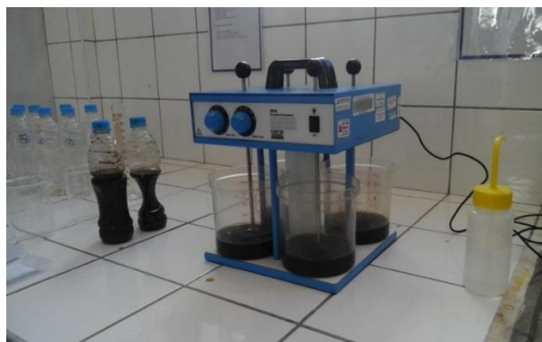
Figura 5: Instalación experimental para el ensayo de coagulación
