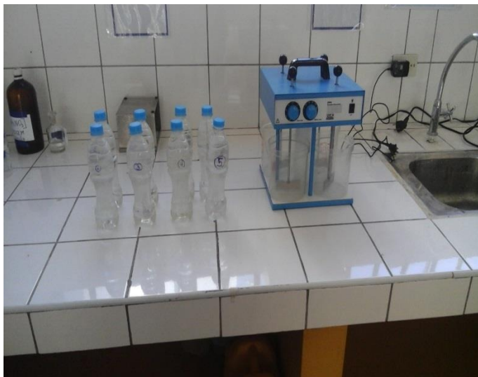
Figura 4: Equipo de Jar test-Facultad de Ingeniería química
