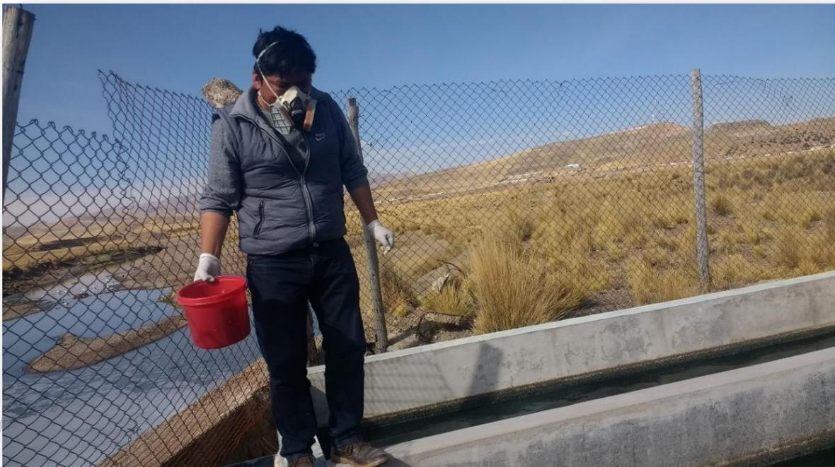
*Ilustración 06: Toma de Muestra para DBO.*
