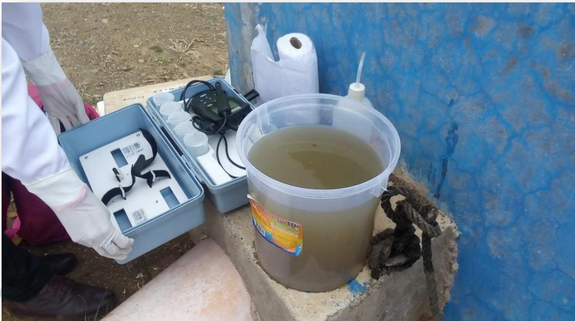
*Ilustración 02: Foto ensayos in situ Afluente PTAR Ayaviri.*
