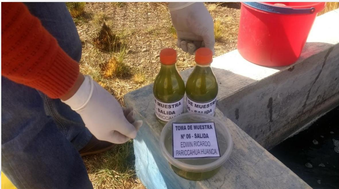
*Ilustración 16: Toma de muestras para análisis físico químico.*
