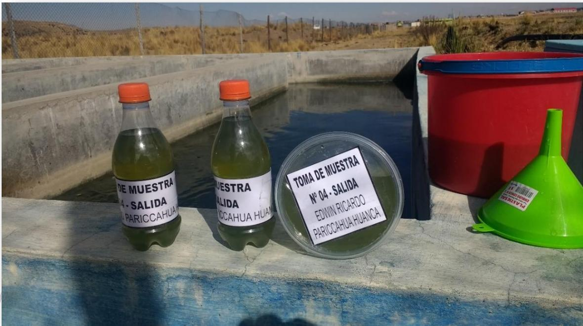
*Ilustración 18: Muestras de agua residual para transporte al laboratorio para su análisis.*
