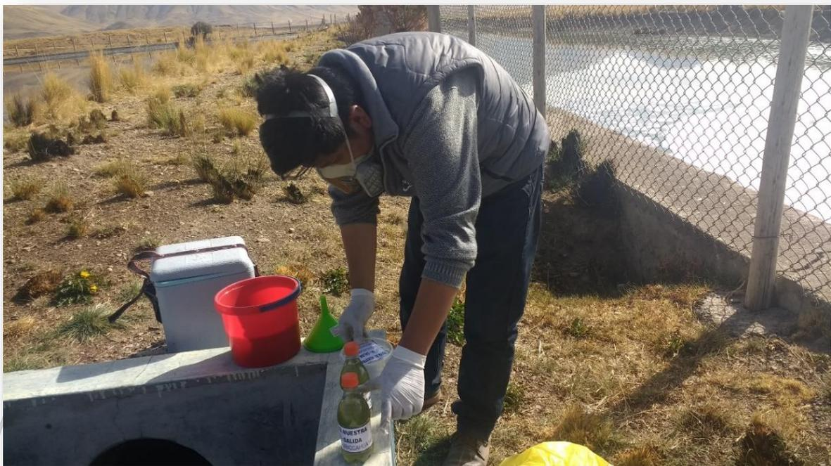
*Ilustración 04: Foto extracción de muestra efluente.*
