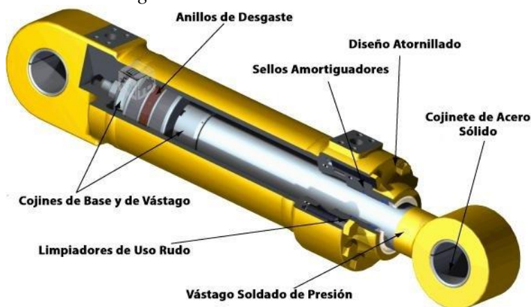
Figura 2. 12: Cilindro Hidráulico
