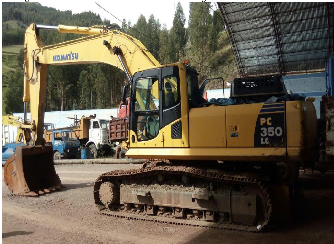
Figura 2. 4: Excavadora hidráulica sobre orugas KOMATSU PC350 LC - 8
