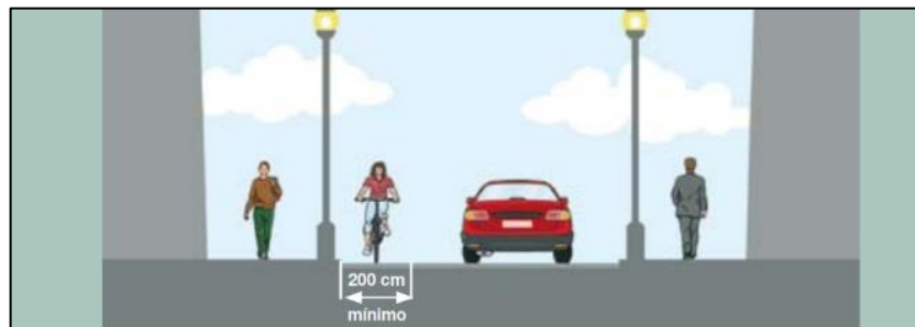
Figura N° 41: Carril bici a contracorriente del tráfico motorizado
