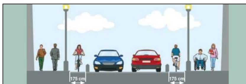
Figura N° 39: Carril bici protegido bidireccional en zona urbana Fuente: Manual para el diseño de vías ciclistas de Cataluña primera edición 2008
