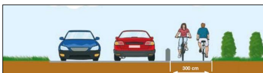
Figura N° 38: Carril bici protegido bidireccional en zona interurbana Fuente: Manual para el diseño de vías ciclistas de Cataluña primera edición 2008
