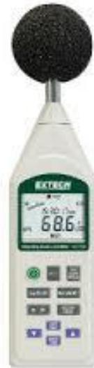
Figura 12. Sonómetro integrador
