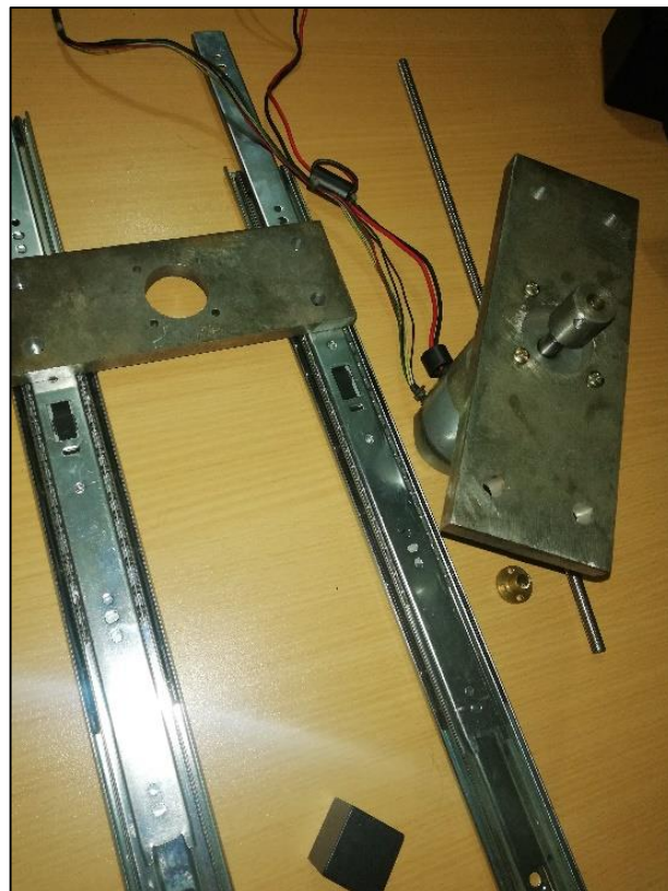
Figura 047: Marcos de acero listos para ensamblar la mesa vibratoria. Fuente: Propia
