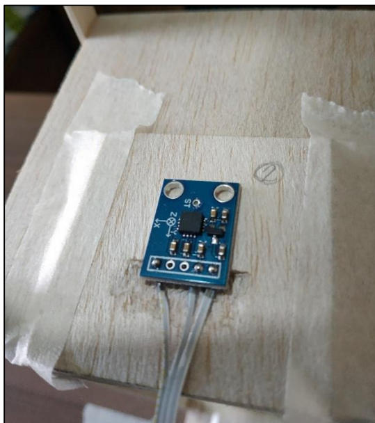
Figura 059: Acelerómetro ADXL335 posicionados en dirección del movimiento. Fuente: Propia
