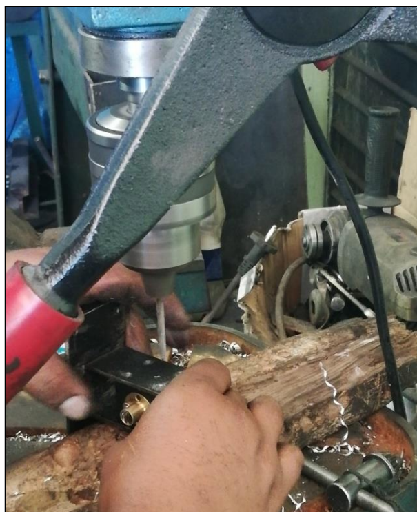
Figura 049: Perforación de la camisa con el NUT para ser acoplado a la plataforma. Fuente: Propia
