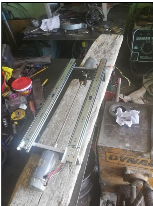
Figura 052: Ensamblado de los marcos de acero al motor. Fuente: Propia
