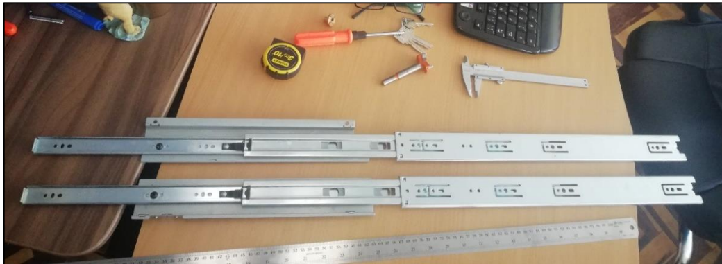
Figura 053: Extensiones de cojinete DYNASLIDE. Fuente: Propia
