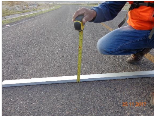
FOTO N° 02: Desnivel carril berma y ahuellamiento en la vía.
