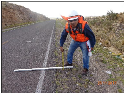
FOTO N° 02: Desnivel carril berma y ahuellamiento en la vía.
