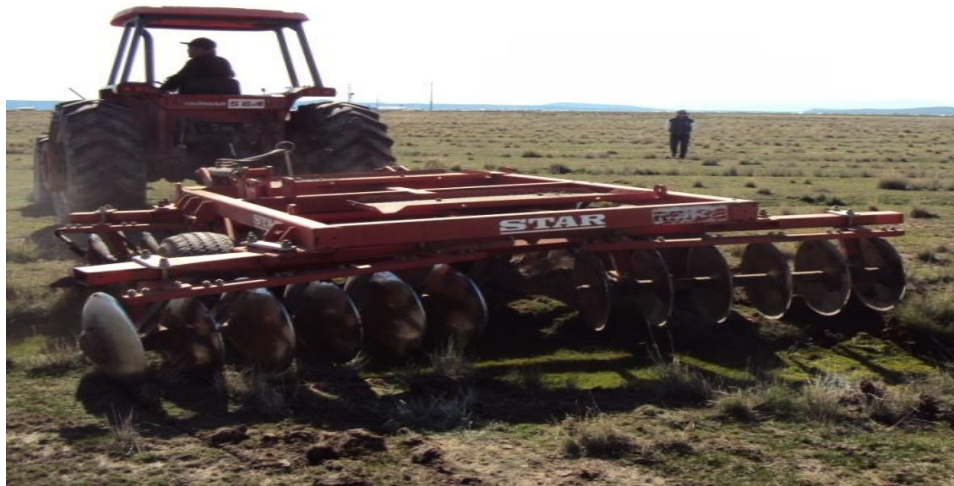
Figura 18. Instalación de los sistemas de labranza “rastra de disco”
