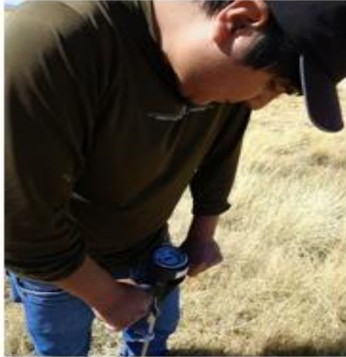
Figura 24. Evaluación de compactación del suelo por efecto de sistemas de labranza al año de clausura
