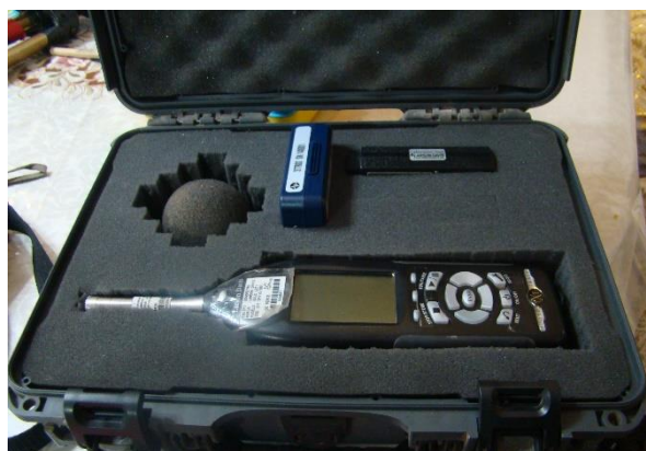
Figura 6. Sonómetro Larson Davis Lxt1, en la ciudad de Cusco, de marzo a setiembre del 2017.
