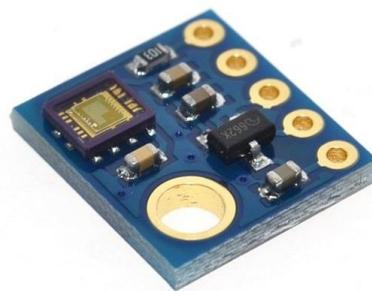
**Figura 4:** *Sensor de detección de luz UV.*
