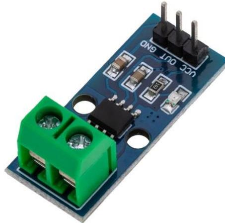
**Figura 5:** *Módulo de sensor de corriente.*
