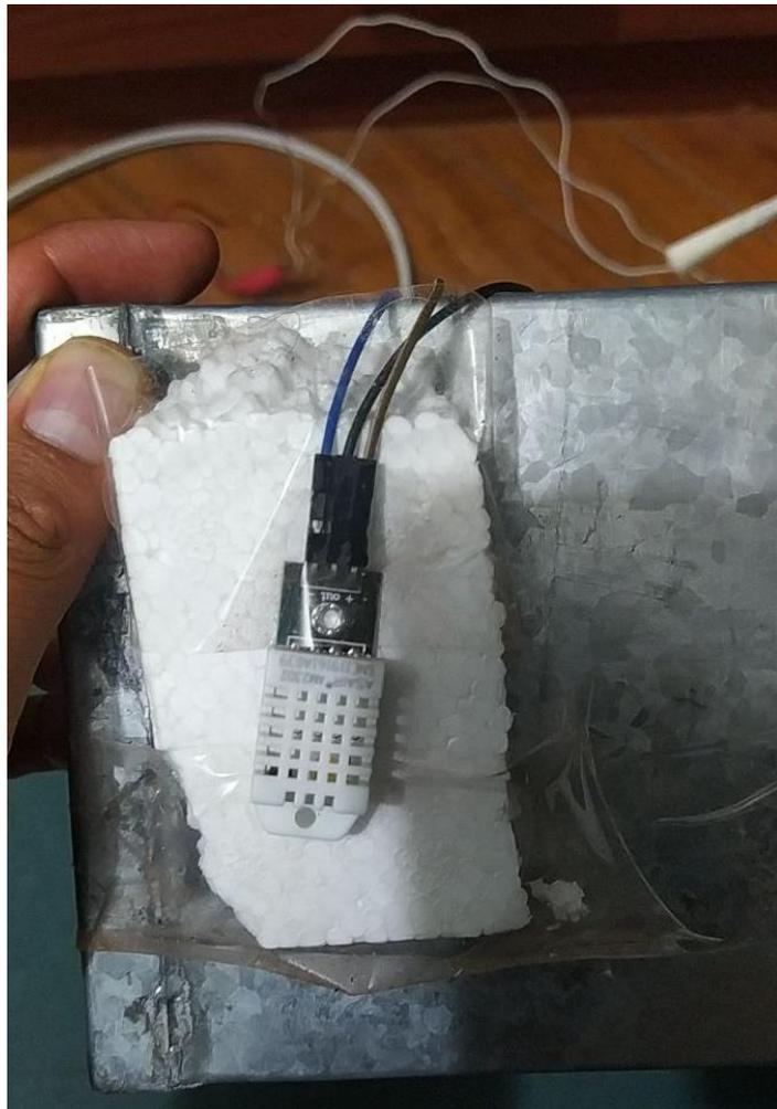
**Figura 33:** *Sensor de temperatura y humedad DHT22.*
