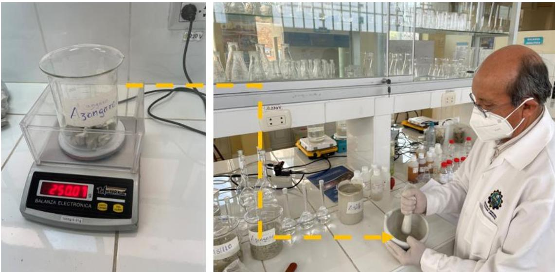
Pesado de caolinita – chaco de 250 g, luego se realizó la pulverización hasta obtener malla – 400 en el Laboratorio de Monitoreo y Evaluación Ambiental en la Facultad de Ingeniería de Minas de la UNA-Puno.
