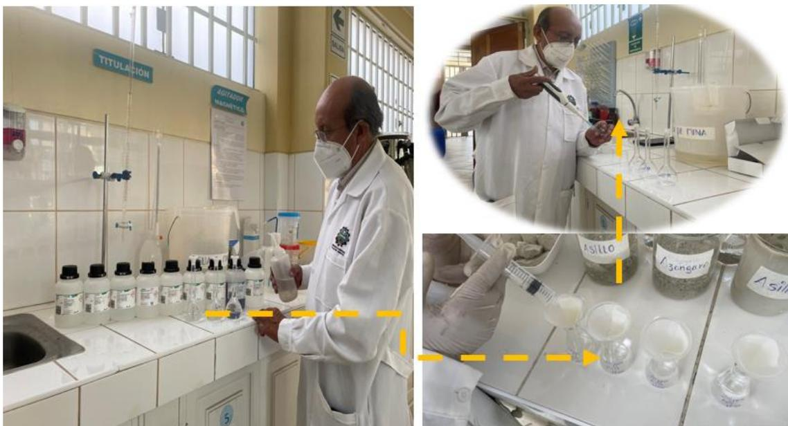
Se llevó a cabo la mezcla de 5 ml de ácido nítrico al 95 % de concentración, seguido por el proceso de filtrado de las muestras en el Laboratorio de Monitoreo y Evaluación Ambiental de la Facultad de Ingeniería de Minas realizándose la curva de calibración para cada metal. Filtrando las muestras tratadas con caolinita – chaco.
