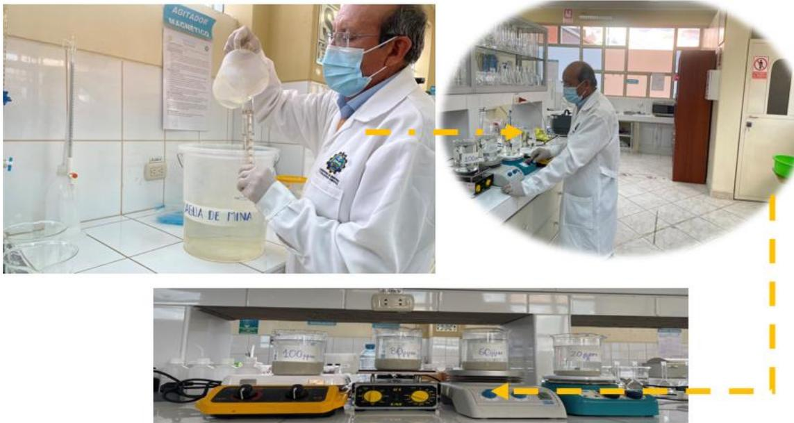
Tratamiento de las muestras de agua de mina de la Minas Los Rosales con Caolinita – Chaco en concentraciones 20 ppm, 60 ppm, 80 ppm y 100 ppm en el Laboratorio durante 14 horas para obtener el mejor tratamiento.
