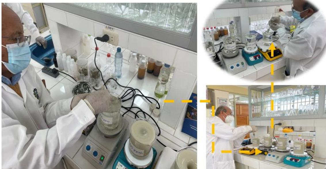
Se preparo la caolinita o chaco  $Al_2Si_2O_5(OH)_4$  en disoluciones para la adición a las muestras según la dosis buscada. Se llenaron en 4 vasos precipitados de 1 L con muestra se añade  $Al_2Si_2O_5(OH)_4$  para obtener diferentes concentraciones. Se colocó una agitación de 100 rpm, 200 rpm y 300 rpm.
