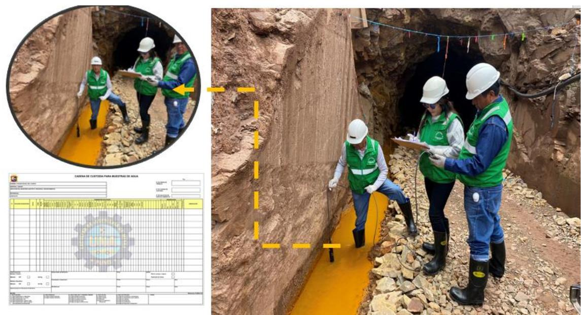
Toma de parámetros fisicoquímicos con el equipo Multiparámetro Hanna Instruments (HI9829) llenando la cadena de custodia in- situ de la bocamina de labor Candelaria junto
