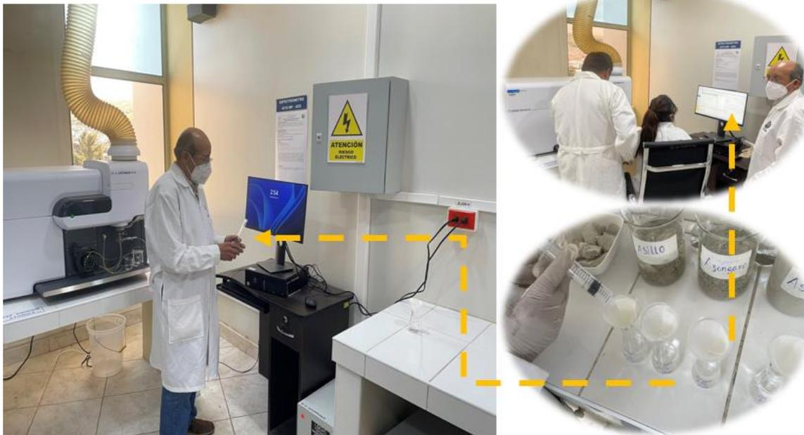
Concentración de metales pesados en las especies se realizó utilizando un espectrofotómetro de emisión atómica con plasma de microondas, específicamente el modelo 4210 MP-AES. Este análisis se llevó a cabo utilizando la longitud de onda para cada metal.
