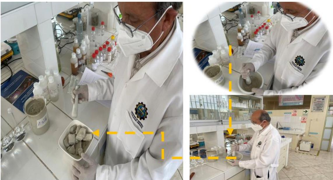
Molienda, trituración y pulverización de la caolinita hasta obtener partículas muy pequeñas para facilitar su posterior procesamiento en las pruebas de Test- Jarr
