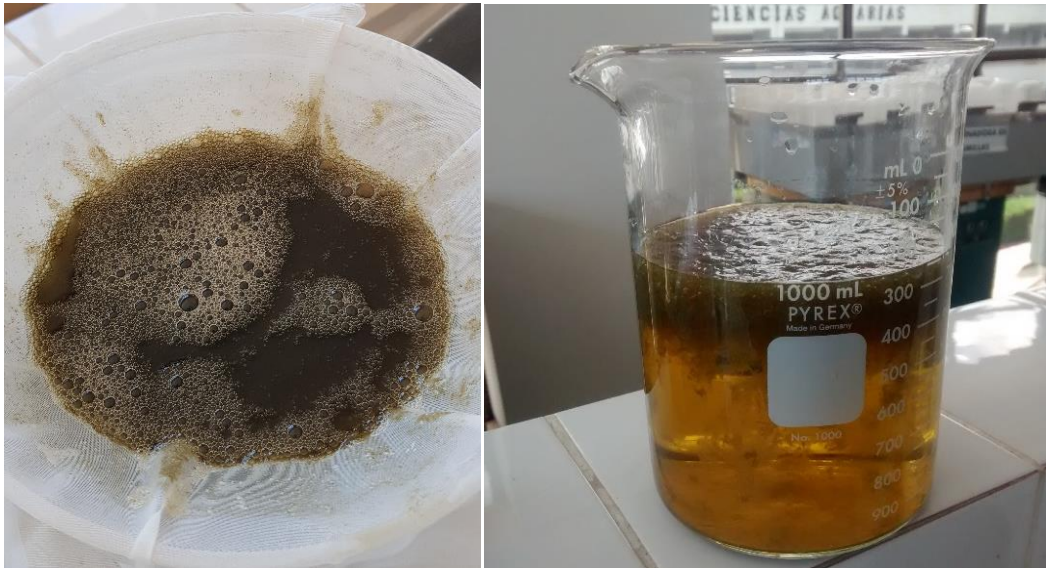
Figura B.4: Filtrado y precipitado en etanol del hidrocoloide del Nostoc
