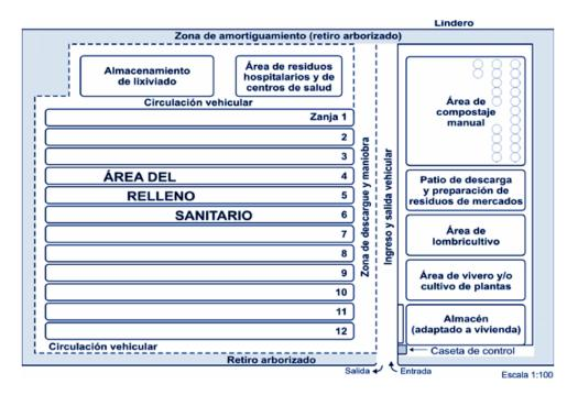
Nota: Vista en planta de un sistema integrado de tratamiento y disposición final de RSM – Gestión de residuos sólidos.
