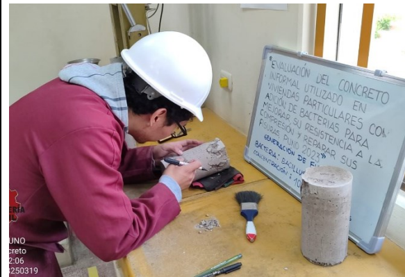
Fotografía 02. Medición de fisuras con el fisuometro.
