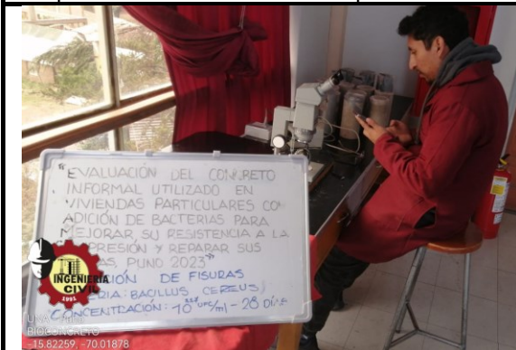
Fotografía 03. Medición de fisuras con el estereoscopio.
