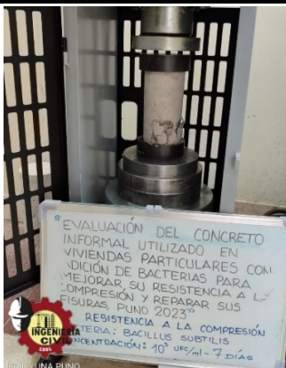
Fotografía 05. Ensayo de resistencia a la compresión – Bacillus Subtilis.
