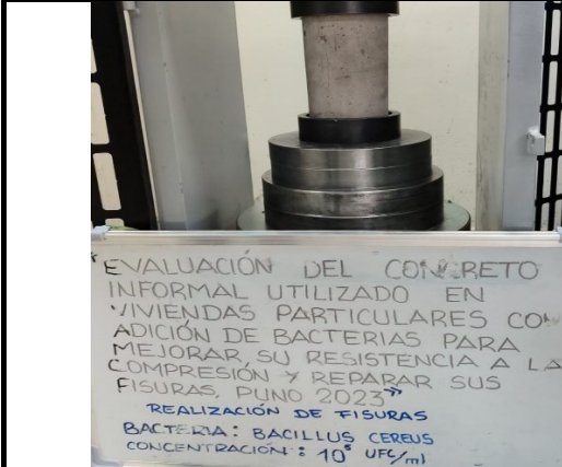
Fotografía 01. Realización de fisuras con la maquina de resistencia a la compresión.
