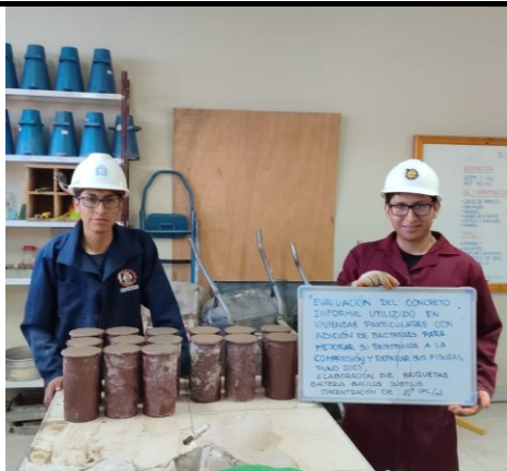
Fotografía 04. Realización de briquetas con aditivo bacteriano.
