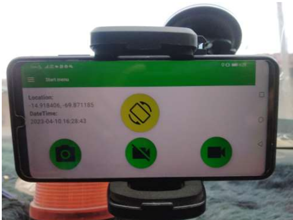
Fotografía 18: Se muestra la presencia de la colocación smartphone en el sujetador para móviles, en el auto para la medición del IRI.
