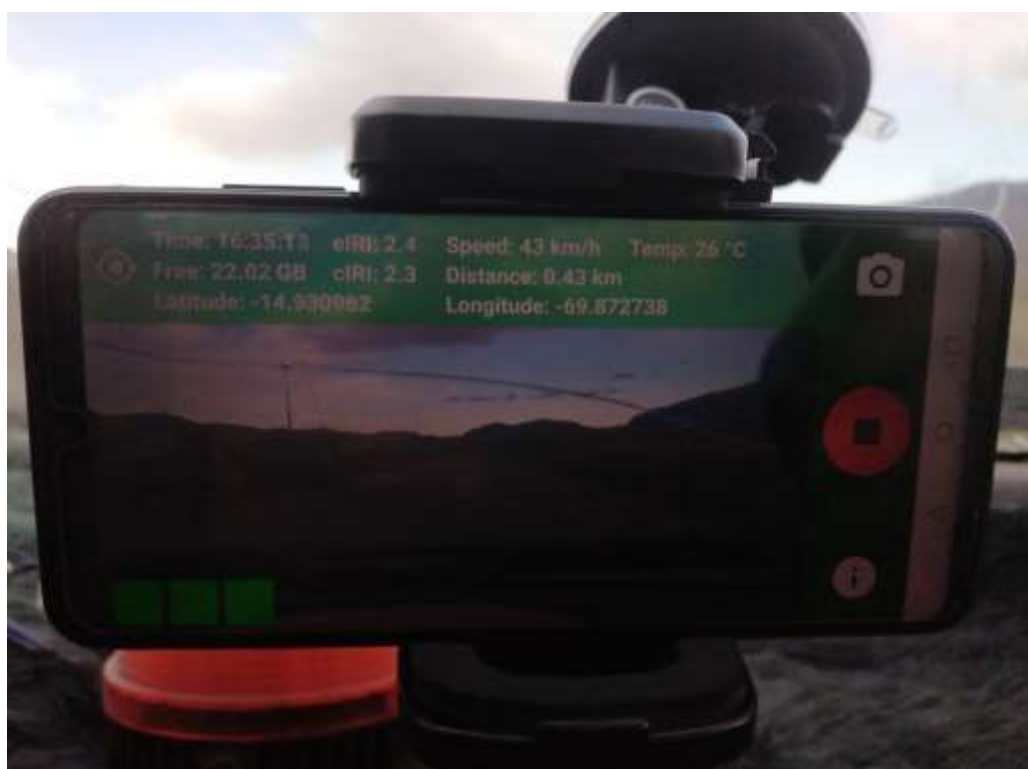
Fotografía 20: Se muestra la presencia de lectura tomada por Roadroid en la progresiva 81+430 km en el tramo II.
