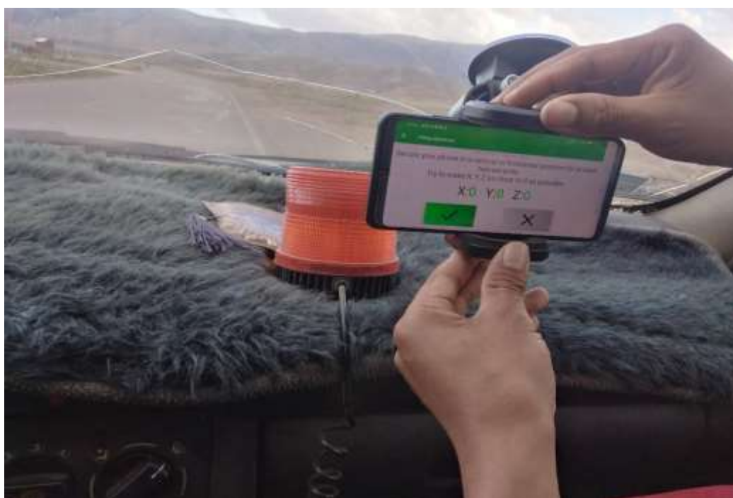
Fotografía 19: Se muestra la presencia de la configuración de la aplicación Roadroid en el Smartphone para la medición del IRI.
