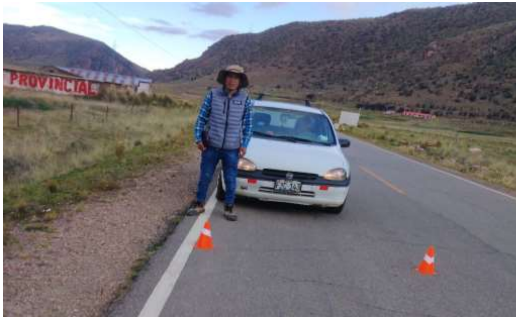
Fotografía 17: Se muestra la presencia del vehículo usado para la medición del IRI un Toyota Corola.
