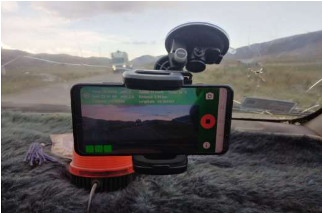
Fotografía 21: Se muestra la presencia de lectura tomada por Roadroid en la progresiva 81+950 km en el tramo II.
