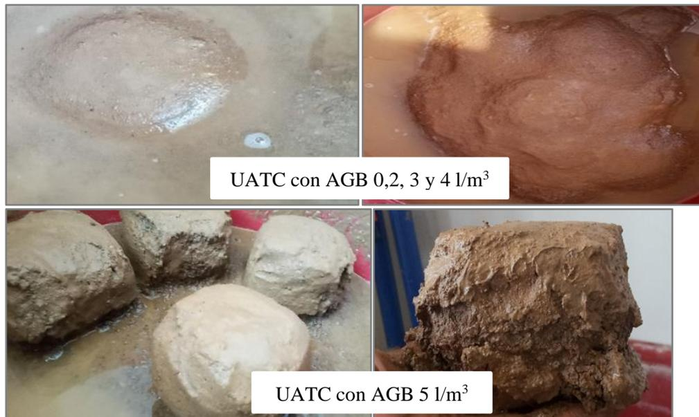
Nota: fotos del ensayo, UATC saturadas y se desintegraron
