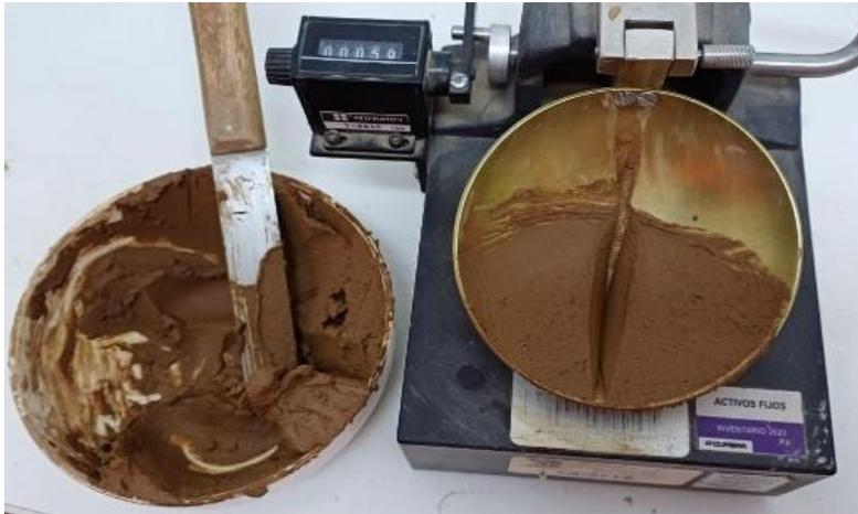
El límite plástico, se determina aplastando sucesivamente entre sí y rodando hasta un diámetro de 3,2 mm (1/8 pulg.). Separe una pequeña cantidad de la masa plástica y reduzca el contenido de agua de la masa hasta que el hilo se agriete y ya no pueda doblarse más, presione la masa juntos y vuelva a aplanarla con el rodillo. El contenido de agua en este punto se conoce como el límite plástico.
