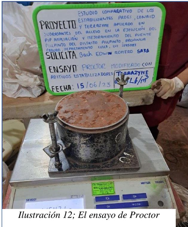
Ilustración 12; El ensayo de Proctor modificado.
