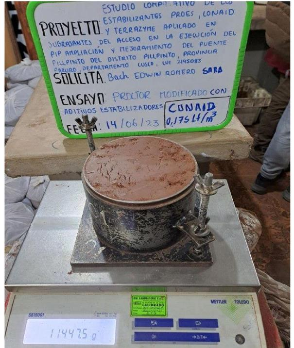
*Ilustración 9; En la imagen adjunta, se muestra el pesaje, para el ensayo de Proctor modificado con la incorporación de Conait.*
