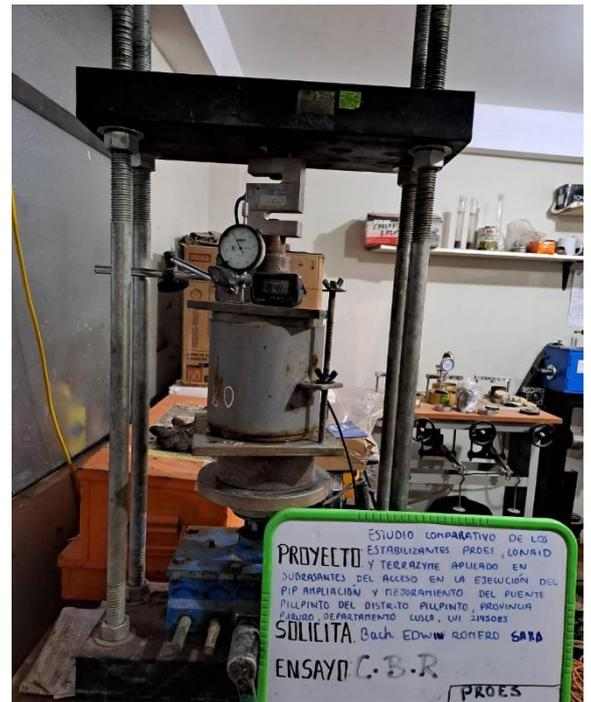
Ilustración 13; El ensayo de CBR.
