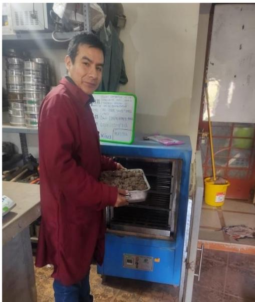
*Ilustración 7; En la imagen mostrada se evidencia el secado muestra en el horno.*
