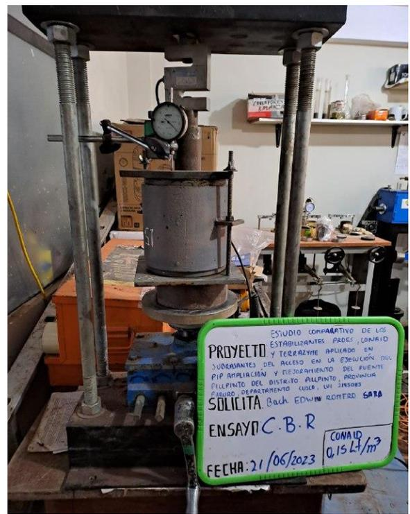
Ilustración 15; El ensayo de CBR.
