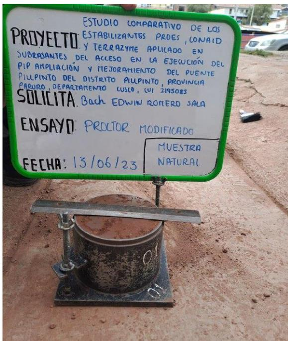
*Ilustración 10; El ensayo de Proctor modificado.*
