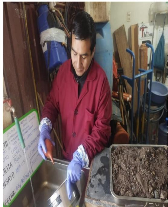
*Ilustración 6; En la imagen adjunta, se evidencia el lavado de muestra, para el análisis granulométrico.*
