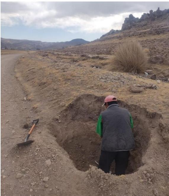
*Ilustración 5; En la imagen adjunta, se muestra la extracción de muestra en la trocha carrozable – Lara Lique*
