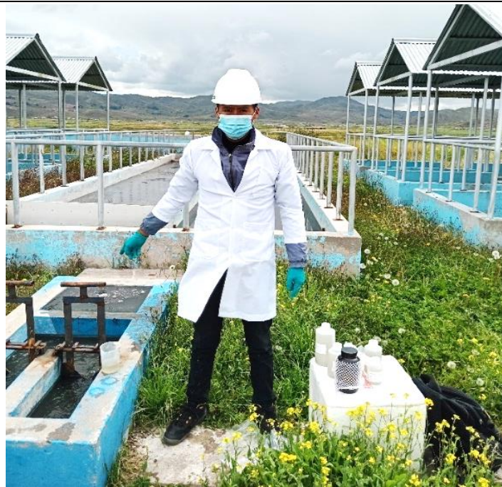
Descripción: Toma de muestra tratamiento primario, sedimentador horizontal MC-03.
