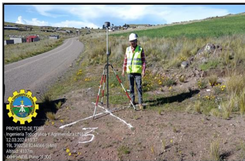
Fotografía 12: Posicionamiento de GNSS navegador SOUTH Galaxy G1 modo ROVER para el establecimiento de fotocontroles FC-03.
