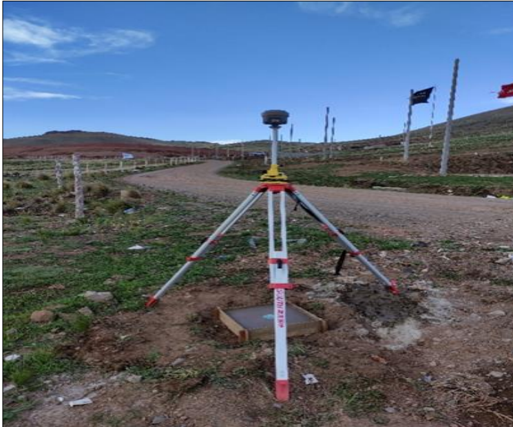
Fotografía 7: Posicionamiento de GNSS navegador SOUTH Galaxy G1- PCG – 01 WGS 1984.
