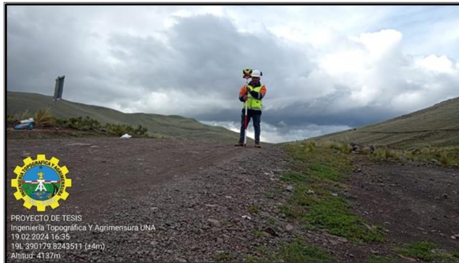
Fotografía 11: Levantamiento topográfico método convencional.
