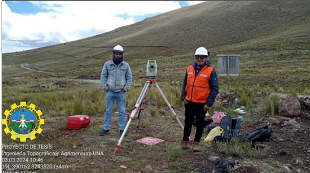
Fotografía 10: Estacionamiento de estación total LEICA TS07.
