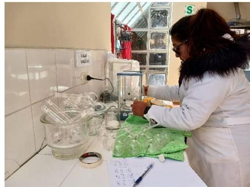
Foto 34. Preparación de balones para nitrógeno Kjeldahl
