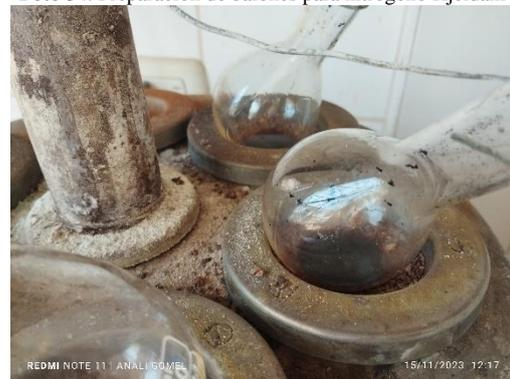
Foto 36. Sulfatación del N de las muestras  $[(\text{NH}_4)_2\text{SO}_4]$
