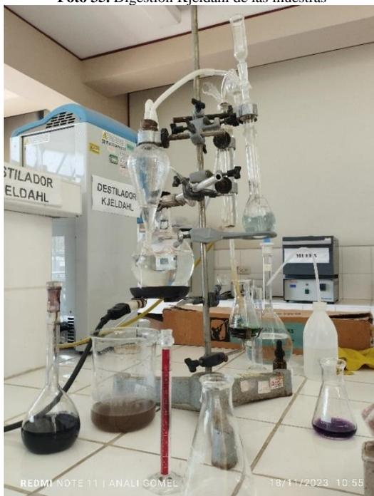
Foto 37. Destilación Kjeldahl  $[(\text{NH}_4)_2\text{SO}_4]$
