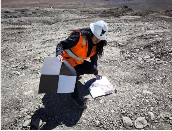
Instalación del punto de control N° 7
