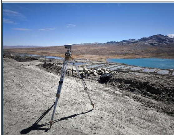
Imagen 3. Base del GPS diferencial instalado.
