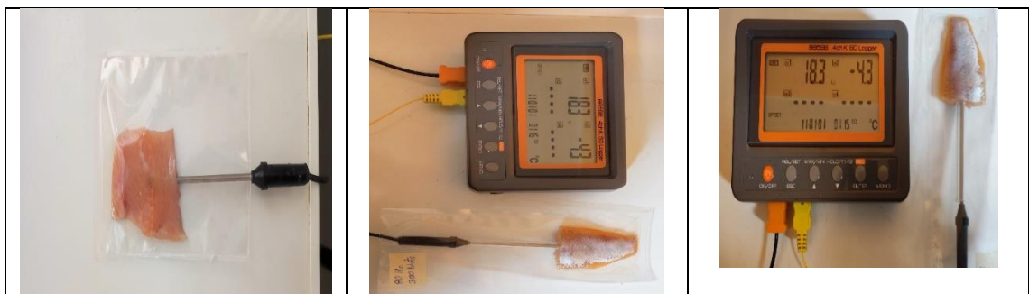
Introduccion de termometro digital en el centro de la muestra para la congelación
