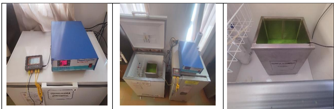
Preparacion de equipos para la congelación por inmersión
