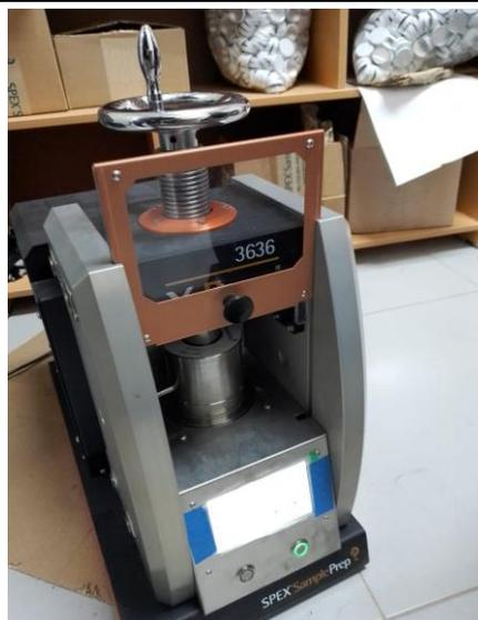
Fotografía 6: Proceso de compactación de muestras en las capsulas para posteriormente ser ensayadas mediante Fluorescencia de rayos X.
