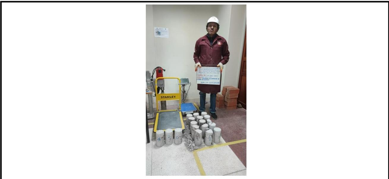
Fotografía 7: Probetas de concreto control, humo de sílice 7.50% y 0.50% de silicato de sodio, ensayadas en el periodo establecido.
