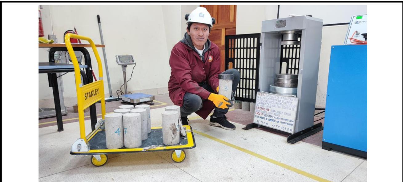
Fotografía 9: Ensayo de resistencia a la compresión de probetas para los periodos de 7 días, 14 días y 28 días.
