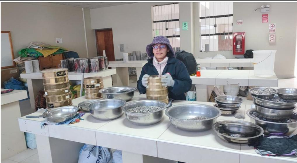
**Fotografía 2: Análisis granulométrico del agregado fino y grueso.**
