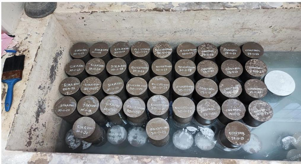
Fotografía 8: Proceso de curado en la poza del Laboratorio de Construcciones de la EPIC.
