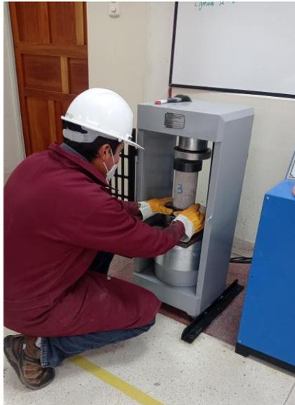
Fotografía 5: Ensayo de resistencia a la compresión de probetas de concreto en los periodos de 7 días, 14 días y 28 días.
