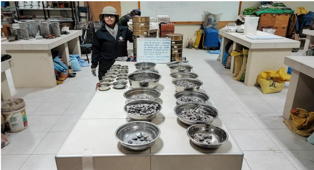
Fotografía 3: Análisis granulométrico del agregado fino y grueso.
