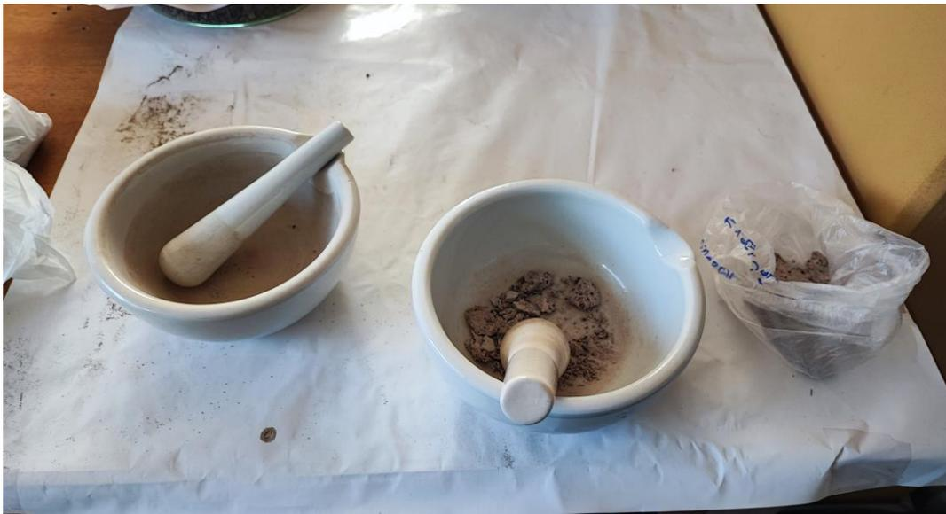
Fotografía 5: Proceso de triturado en mortero de muestras para posteriormente tamizar por la malla Nro. 400.
