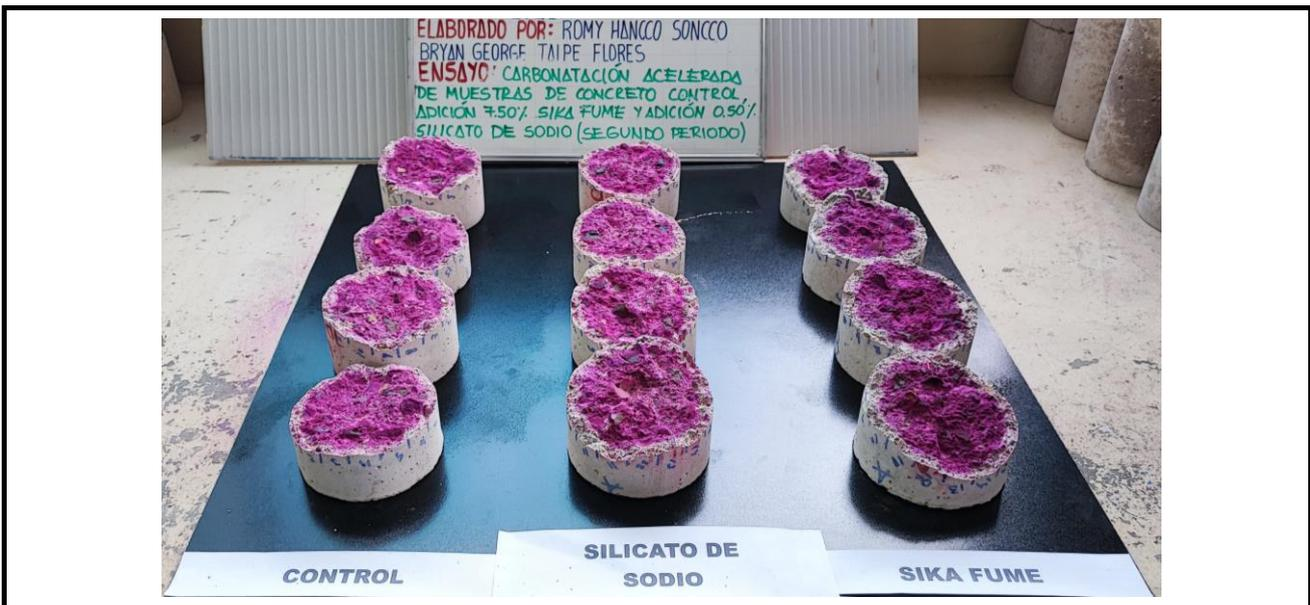
Fotografía 9: Muestras ensayadas de carbonatación acelerada para el segundo periodo.
