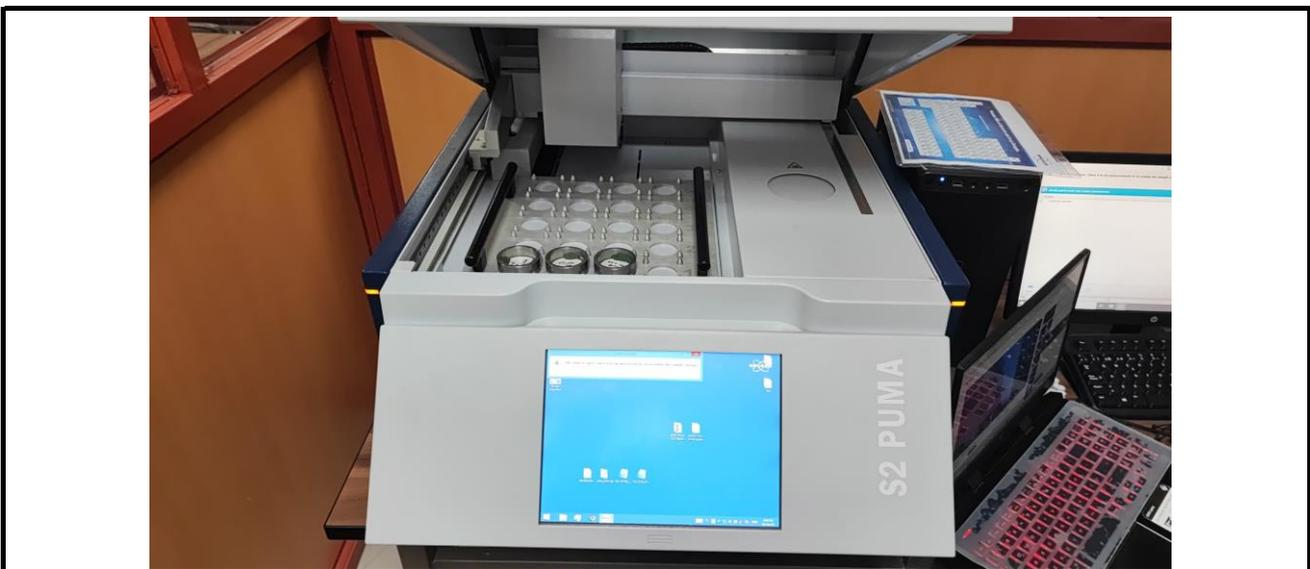
Fotografía 10: Muestras colocadas en el equipo para realizar el ensayo de Fluorescencia de Rayos X.
