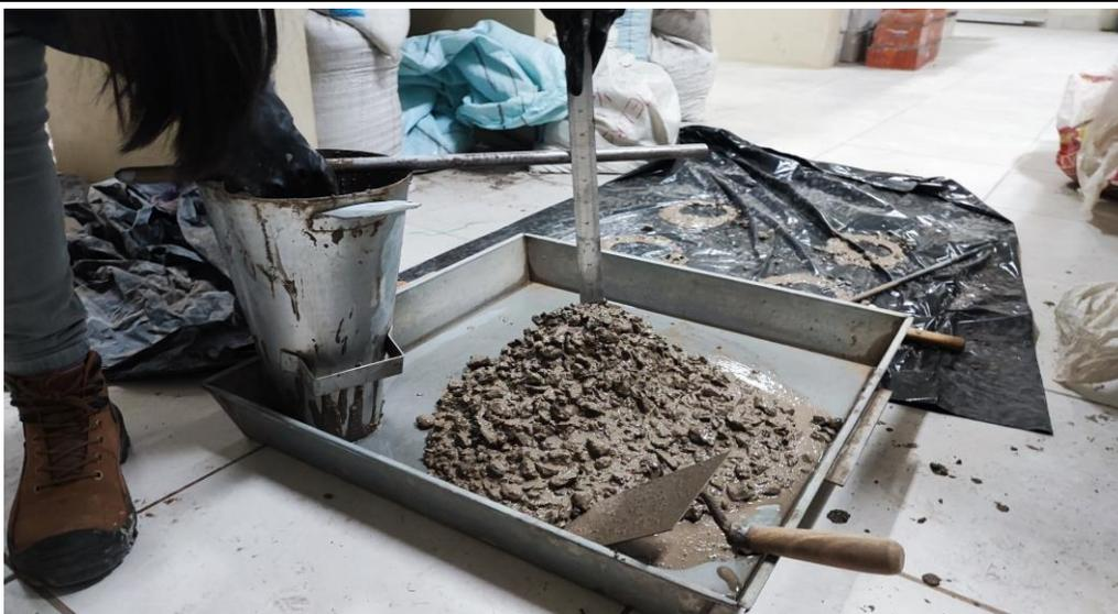
**Fotografía 6: Ensayo de Slump para todos los diseños de mezclas elaboradas.**
