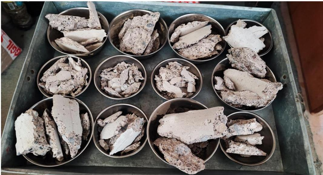
Fotografía 3: Trozos de muestras con exposición y sin exposición a la solución de sulfato de magnesio heptahidratado.
