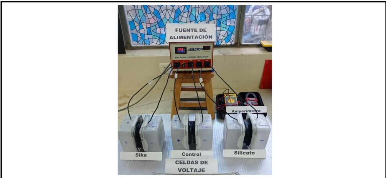
Fotografía 3: Muestras listas previo al ensayo de ion cloruro.
