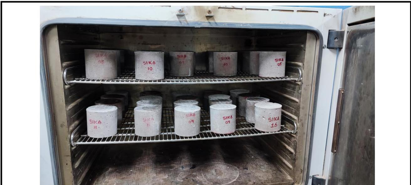
Fotografía 1: Pre acondicionamiento de probetas para realizar el ensayo de carbonatación acelerada.
