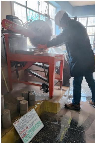
Fotografía 1: Proceso de corte de muestra de acuerdo a la norma ASTM C 1202.
