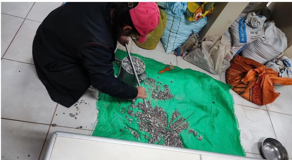
Fotografía 4: Ensayo de peso unitario suelto y compactado del agregado fino y grueso.
