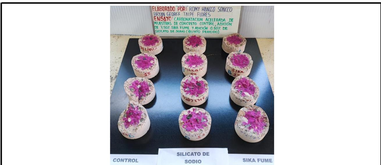
Fotografía 12: Muestras ensayadas de carbonatación acelerada para el quinto periodo.
