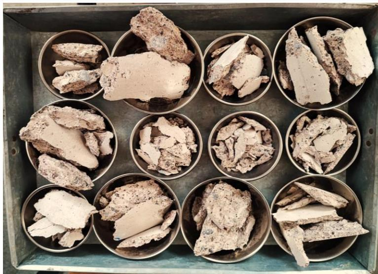
Fotografía 4: Trozos de muestras con exposición y sin exposición a la solución de sulfato de magnesio heptahidratado.
