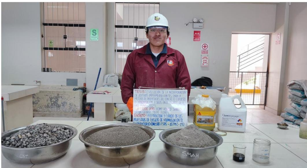
Fotografía 1: Materiales para la elaboración de probetas de concreto con el porcentaje apropiado de acuerdo a los resultados previamente.
