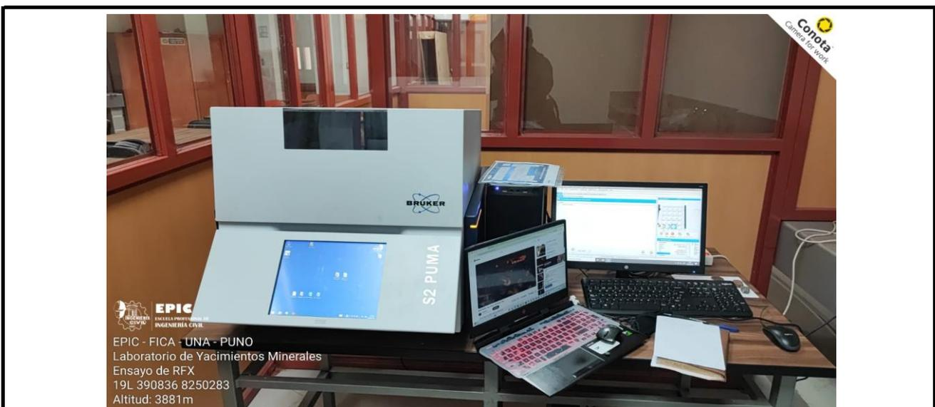
Fotografía 8: Equipo de Fluorescencia de rayos X, marca Bruker, modelo S2 Puma.
