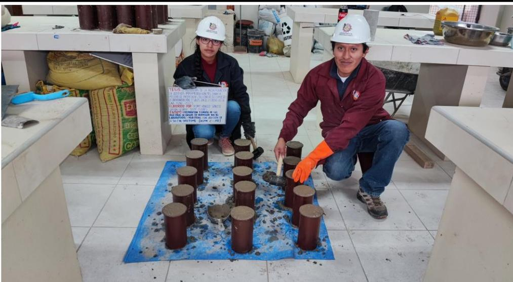
Fotografía 2: Elaboración de probetas de concreto de 4"x8" para el concreto control, humo de sílice 7.50% y silicato de sodio 0.50%.
