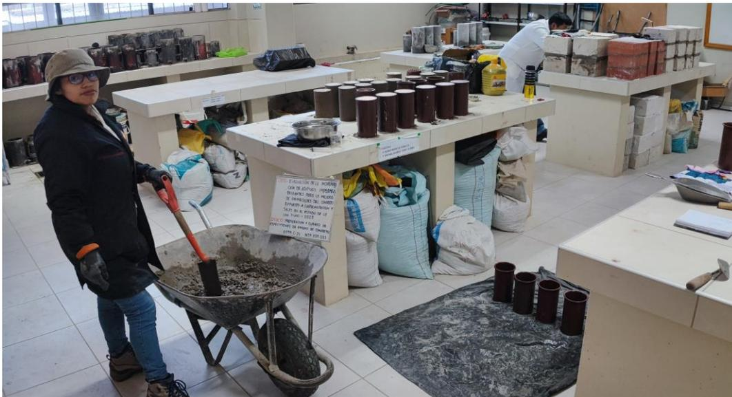
**Fotografía 5: Elaboración de especímenes de acuerdo a los diseños de mezclas elaborados con las adiciones especificadas.**
