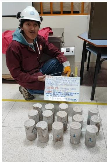
Fotografía 6: Probetas de concreto control, humo de sílice 7.50% y 0.50% de silicato de sodio, ensayadas en el periodo establecido.
