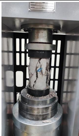
Fotografía 12: Especímenes de concreto de 4"x8" ensayados a los 28 días.
