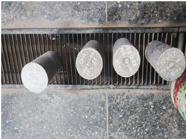
Fotografía 11: Probetas expuestas a la solución de sulfato de magnesio heptahidratado para su posterior ensayo a la resistencia a la compresión.
