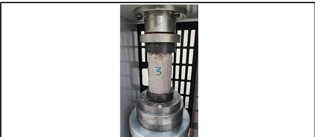
Fotografía 10: Especímenes de concreto de 4"x8" ensayados a los 7 días.
