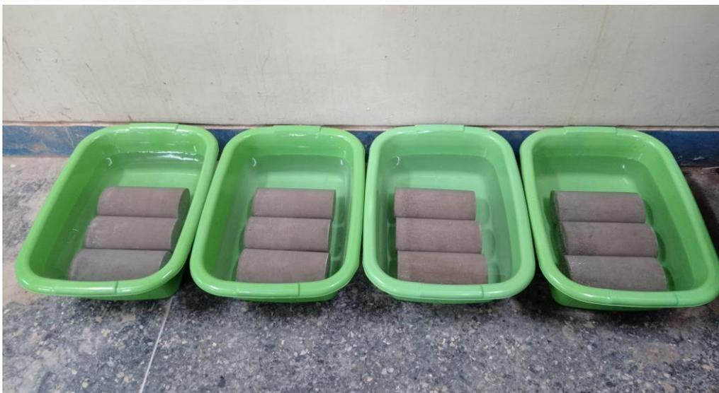
Fotografía 2: Muestras expuestas a la solución de sulfato de magnesio heptahidratado.
