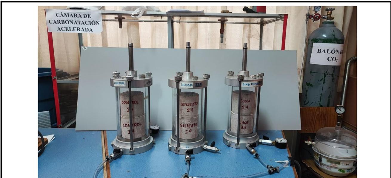
Fotografía 5: Muestras en proceso de carbonatación acelerada.
