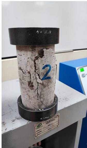
Fotografía 11: Especímenes de concreto de 4"x8" ensayados a los 14 días.
