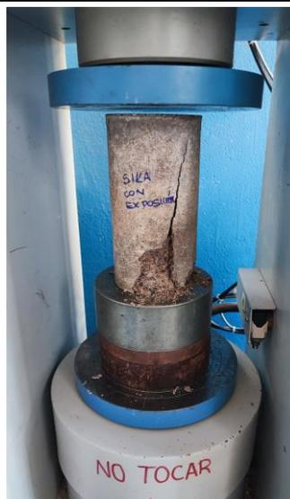
Fotografía 12: Ensayo de resistencia a la compresión de muestras con y sin exposición a la solución de sulfato de magnesio heptahidratado.
