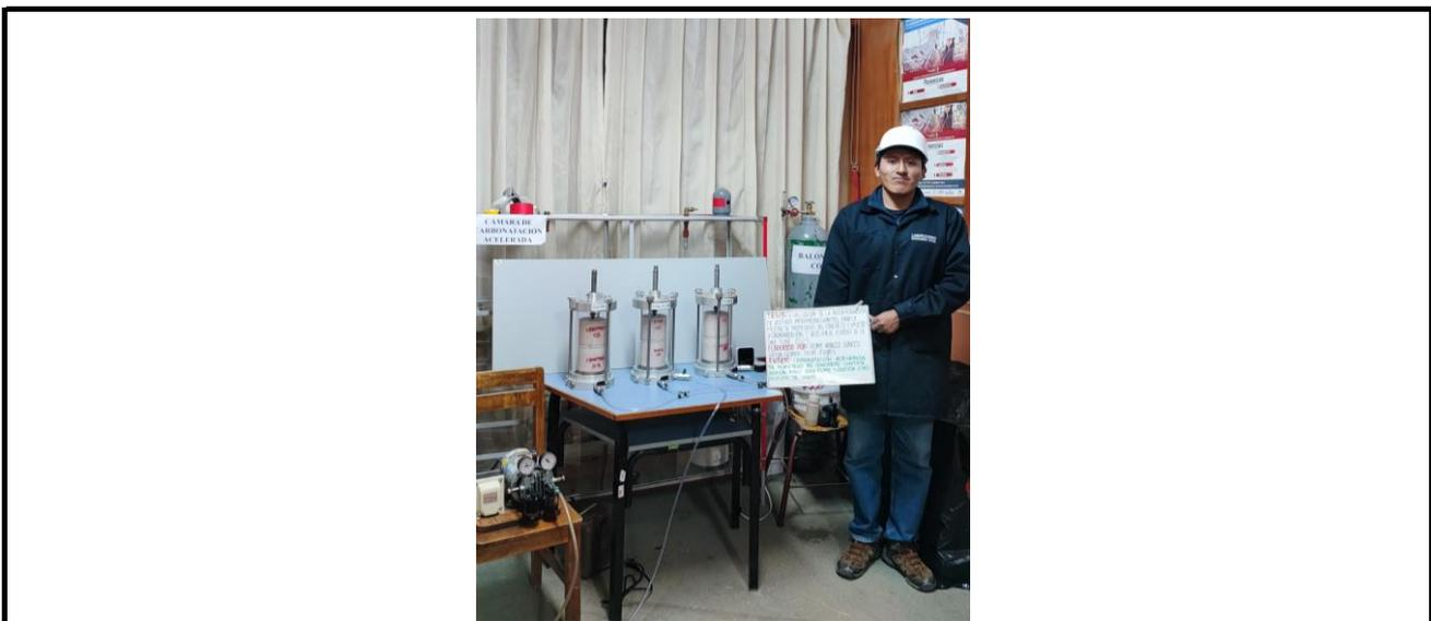
Fotografía 4: Cámara hermética de carbonatación acelerada.
