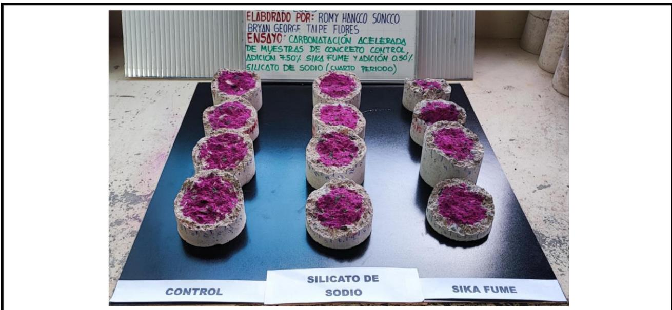
Fotografía 11: Muestras ensayadas de carbonatación acelerada para el cuarto periodo.
