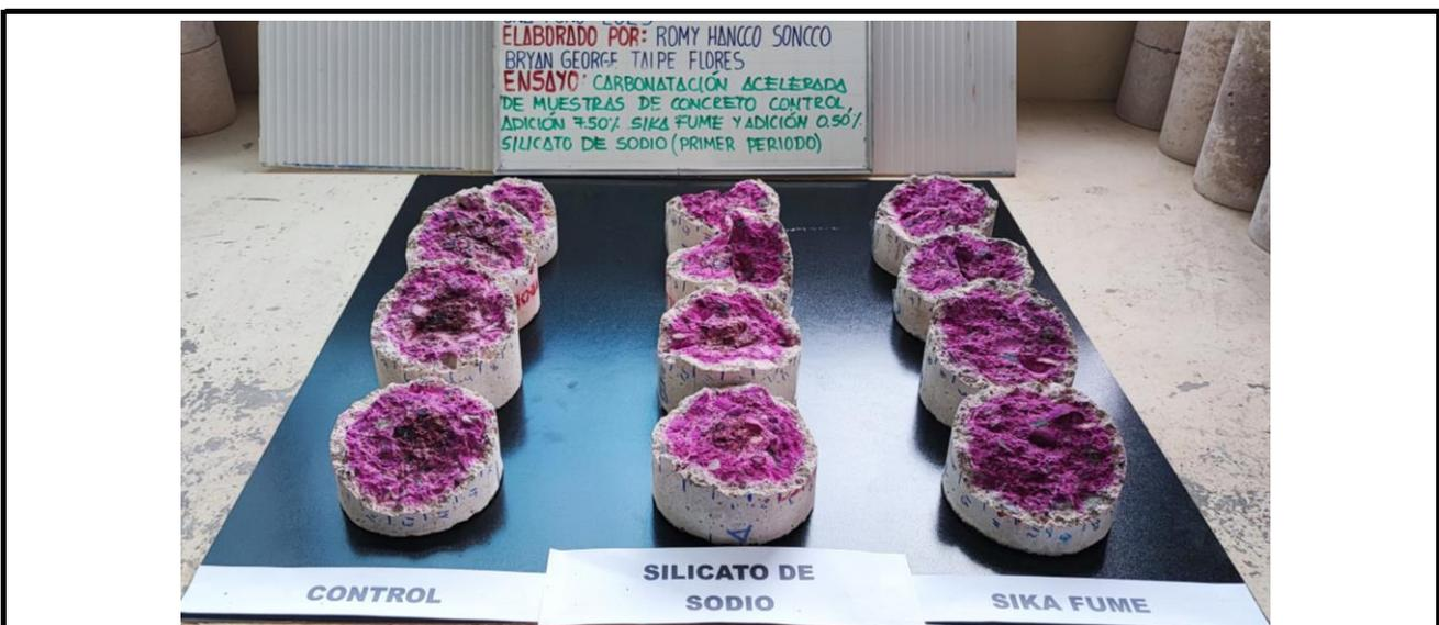
Fotografía 8: Muestras ensayadas de carbonatación acelerada para el primer periodo.
