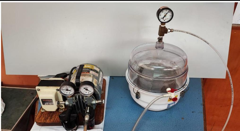
Fotografía 2: Proceso de eliminación de vacíos de las muestras con una bomba de vacíos y agua destilada, para su posterior ensayo a ion cloruro.
