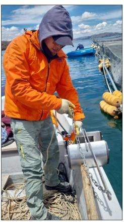
**Nota:** Se utilizó una draga tipo Van Venn de un área de 0.05 m<sup>2</sup>.
