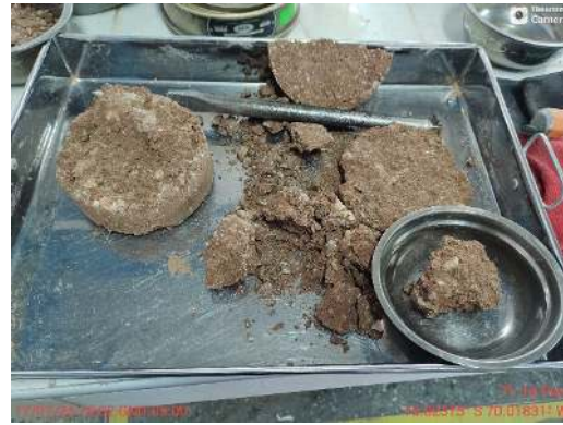
Ensayo Proctor Modificado
