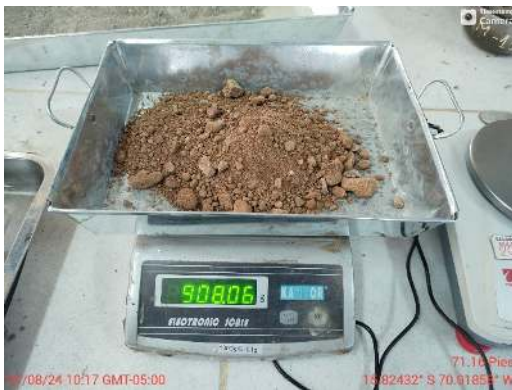
Ensayo Contenido de Humedad Natural
