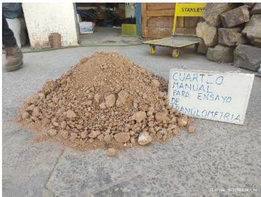
Cuarteo manual de material para ensayos
