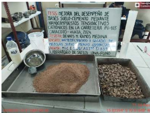
Ensayo Humedecimiento/Secado - Durabilidad
