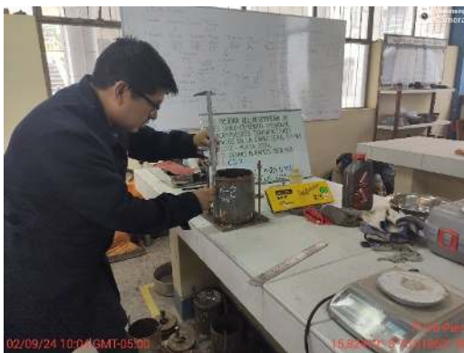
Ensayo CBR – Medidas de molde
