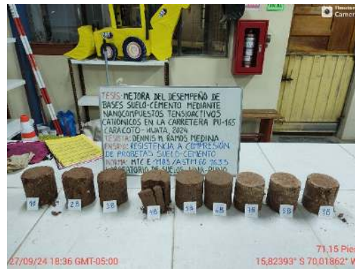
Ensayo Resistencia a la Compresión
