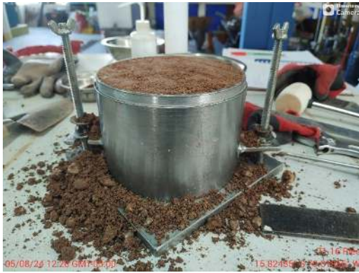
Ensayo Proctor Modificado
