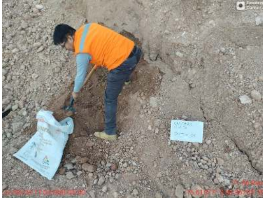
Extracción de suelo en cantera
