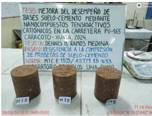
Ensayo Resistencia a la Compresión
