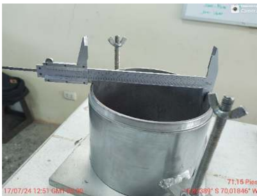
Ensayo Proctor Modific. – Medidas de molde
