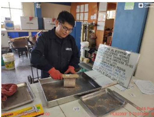
Ensayo Humedecimiento/Secado – Durabilidad
