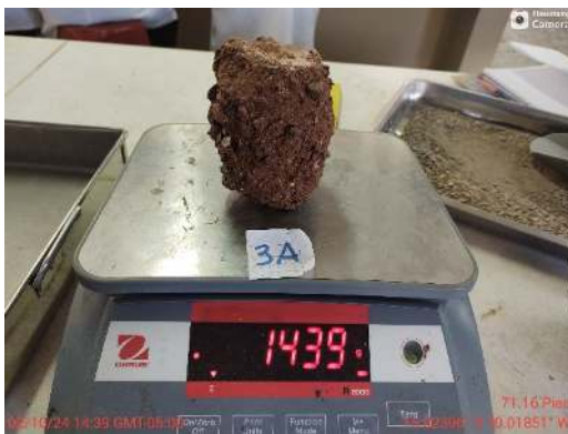
Ensayo Humedecimiento/Secado - Durabilidad
