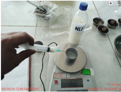
Ensayo CBR – Medida de aditivo
