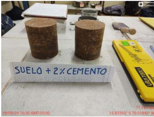
Ensayo Humedecimiento/Secado – Durabilidad
