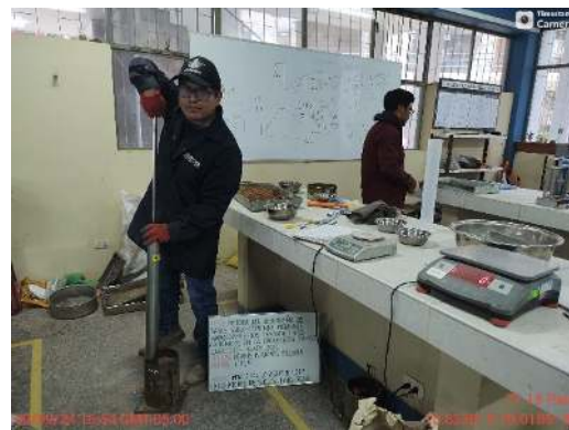
Ensayo CBR – Medidas de molde
