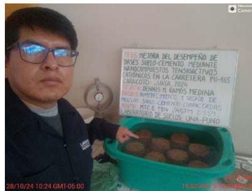
Ensayo Humedecimiento/Secado - Durabilidad
