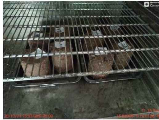
Ensayo Humedecimiento/Secado - Durabilidad
