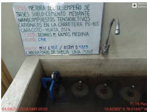
Ensayo CBR – Sumergido de muestras
