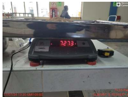
Ensayo Proctor Modificado
