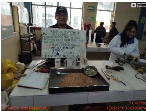
Ensayo Proctor Modificado
