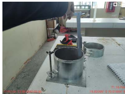
Ensayo Proctor Modific. – Medidas de molde
