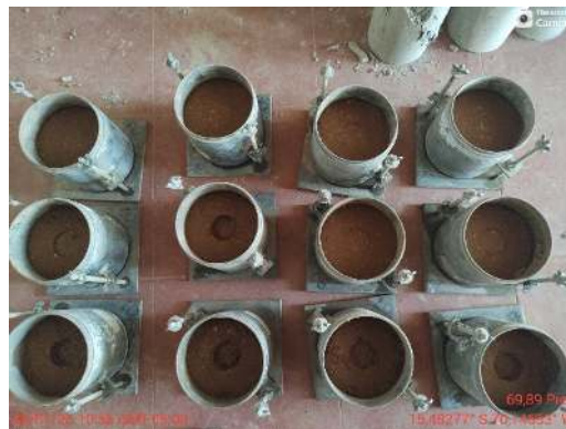
Muestras CBR después del punzonamiento
