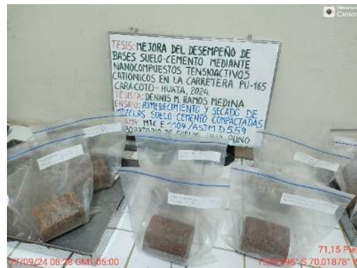
Ensayo Humedecimiento/Secado - Durabilidad
