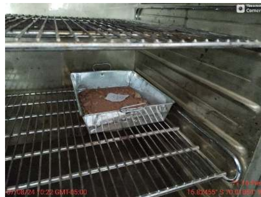
Ensayo Contenido de Humedad Natural
