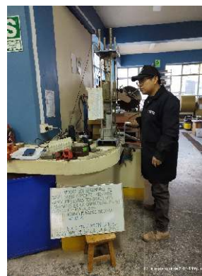
Ensayo CBR – Lectura en equipo
