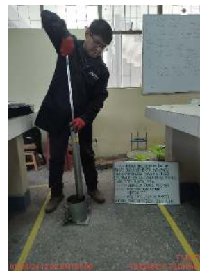
Ensayo Proctor Modificado
