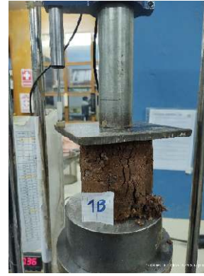
Ensayo Resistencia a la Compresión
