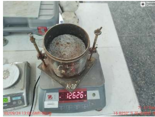
Ensayo CBR – Peso de molde mas muestra
