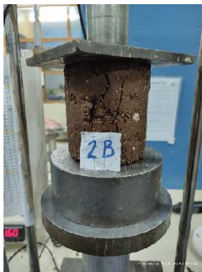
Ensayo Resistencia a la Compresión
