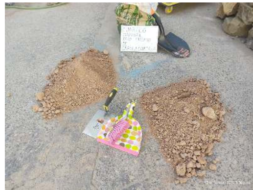
Cuarteo manual de material para ensayos
