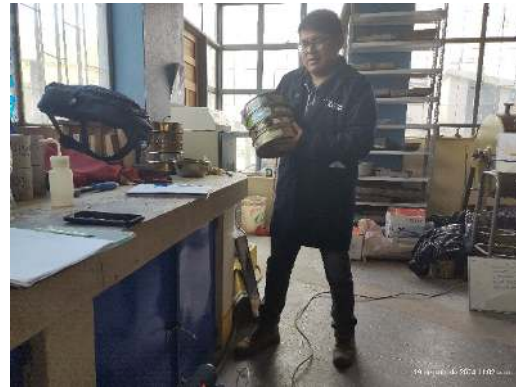
Análisis Granulométrico de suelos por tamizado
