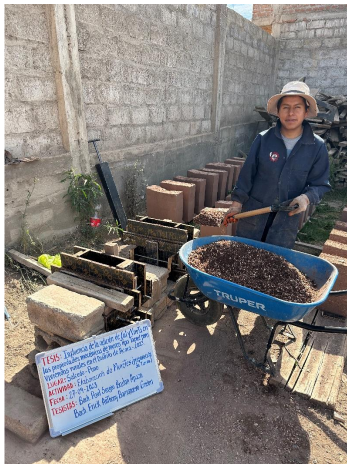
Fotografía 10. Proceso de combinación de materiales para la elaboración de muretes
