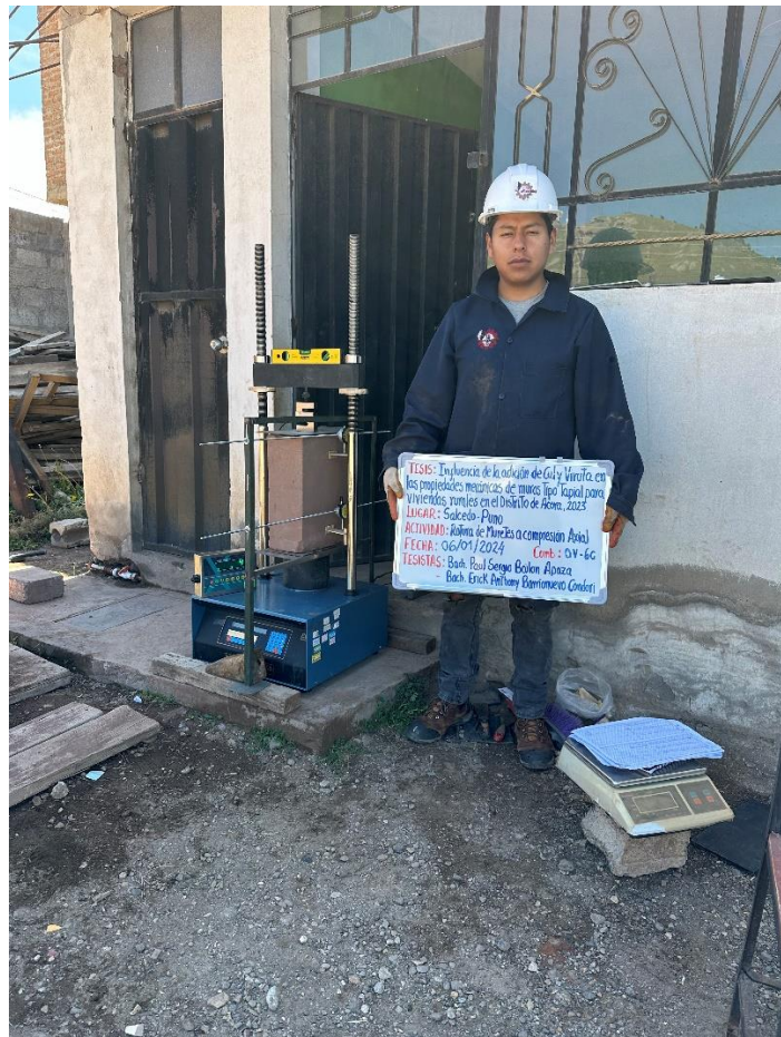
Fotografía 12. Rotura a Compresión Axial de muretes
