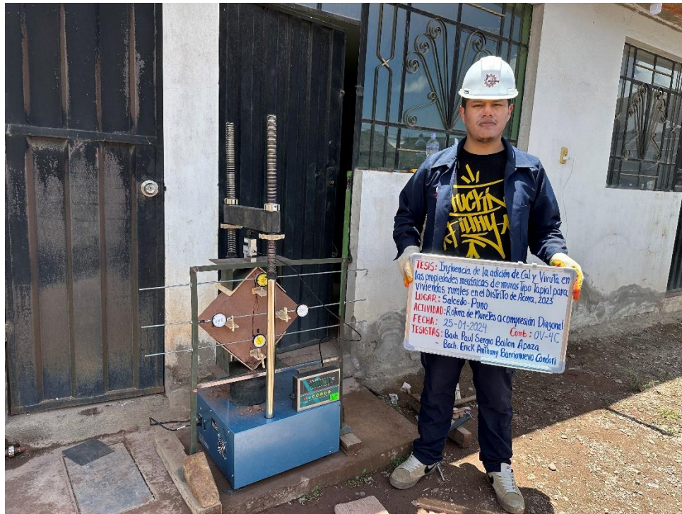
Fotografía 13. Rotura a Compresión Diagonal de muretes
