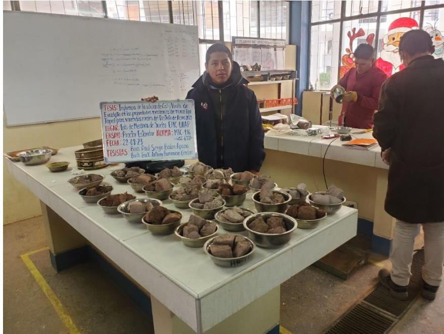
Fotografía 7. Determinación del contenido de Humedad Proctor
