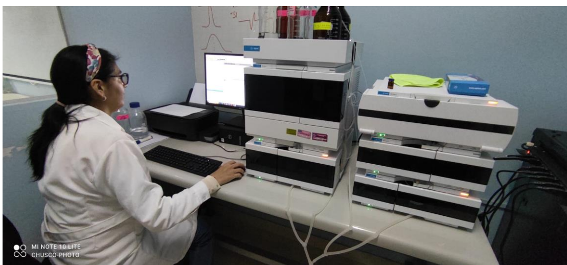
Figura 4: Lectura de muestras cuantificadas a 12 minutos, longitud de onda \lambda : 280 nm y obtención de cromatogramas.
