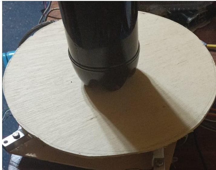
Figura 14: Cobertura de los sensores de peso Elaboración propia
