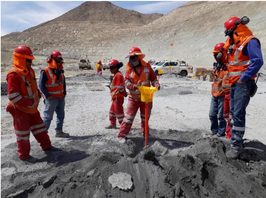
Nota: Colocado de Wayra Fast en el Taladro
